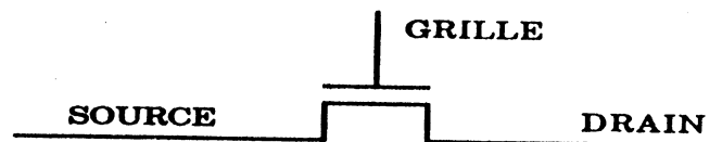
FIG. 30 : L'ELEMENT DE BASE DU NIVEAU SWITCH
