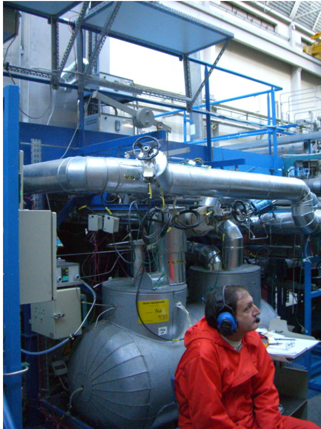
FIG. 2.2 – Photo du circuit de recirculation de l’expérience VKS avec au premier plan André Skiara. On remarque en particulier la cuve de stockage au point le plus bas de l’expérience, tandis que la cuve d’essai est montée sur une plate forme.
