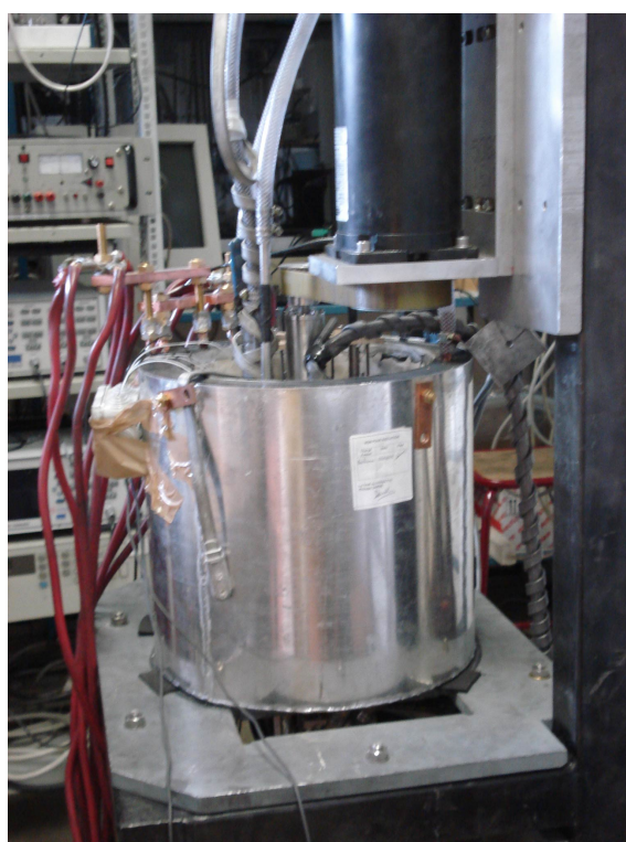
FIG. 2.11 – Photographie de la cuve expérimentale, entourée du solénoïde produisant un champ magnétique vertical.
