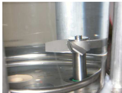
FIGURE 2.9 – Photo d'une hélice prise lors des mesures préliminaires avec de l'eau.
