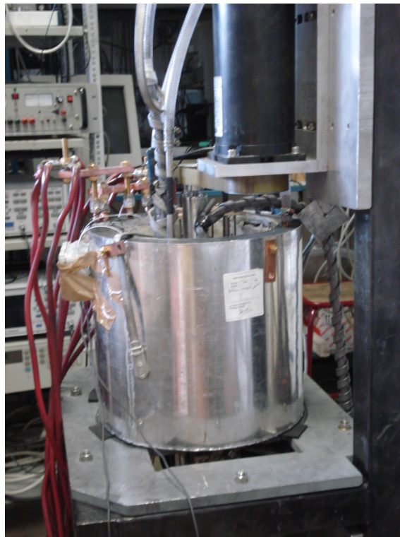
FIGURE 2.11 – Photographie de la cuve expérimentale, entourée du solénoïde produisant un champ magnétique vertical.
