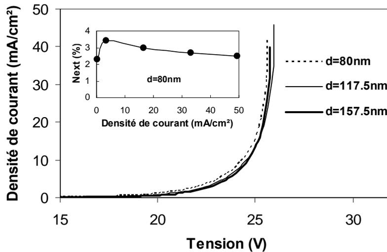
**Figure III.13** : Caractéristiques J-V pour  $d = 80, 117.5$  et  $157.5$  nm respectivement. Le rendement quantique externe en fonction de la densité de courant est donné en insertion.
