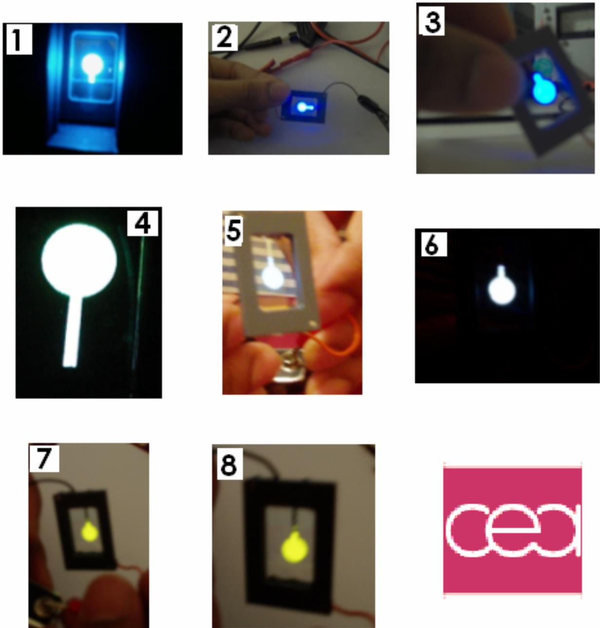
**Figure II.23** : Photos de quelques OLEDs réalisées au CEA : (1-2-3) : OLEDs bleues à base de NPB/DPVBi, (4-5-6) : OLEDs blanches à base de NPB/DPVBi et de (1 nm) de Rubrène, (7-8) : OLEDs jaunes à base de NPB/DPVBi et de (1 nm) de Rubrène.
