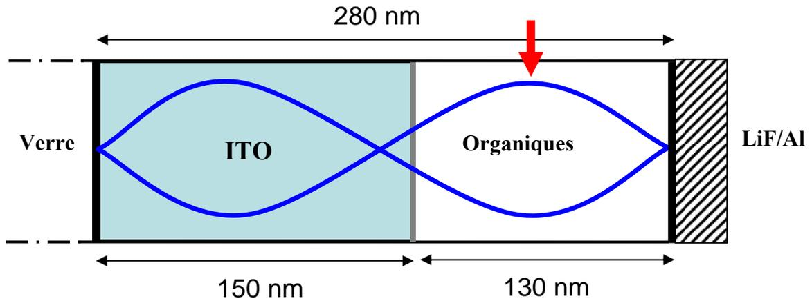
**Figure II.9 :** Evolution schématique de l'enveloppe du champ optique dans la structure correspondant à une émission bleue. La flèche correspond à un maximum du champ pour le bleu et à l'endroit où il faut placer la zone de recombinaison.
