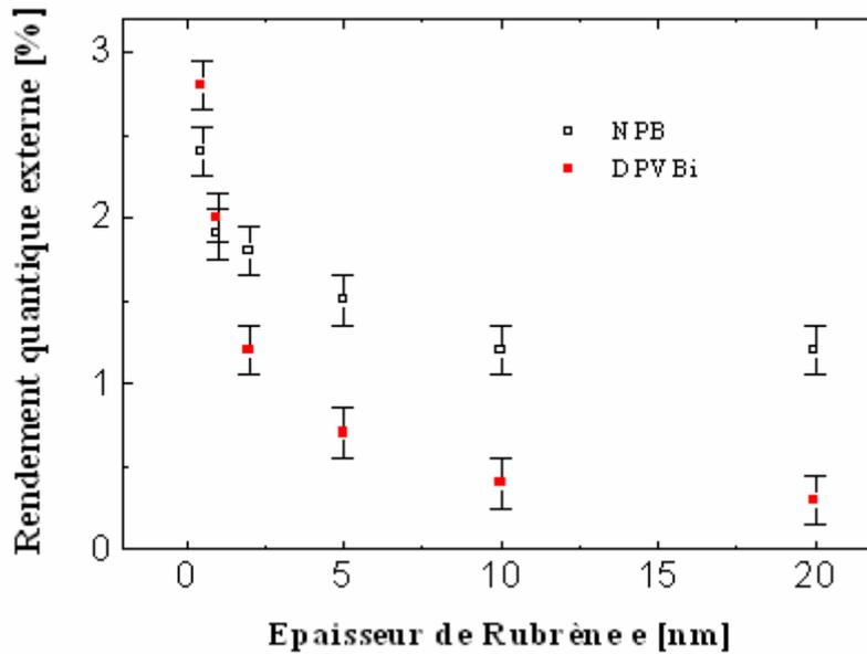
**Figure II.17 :** Rendement quantique externe en fonction de l'épaisseur de Rubrène  $e$  pour les deux structures.
