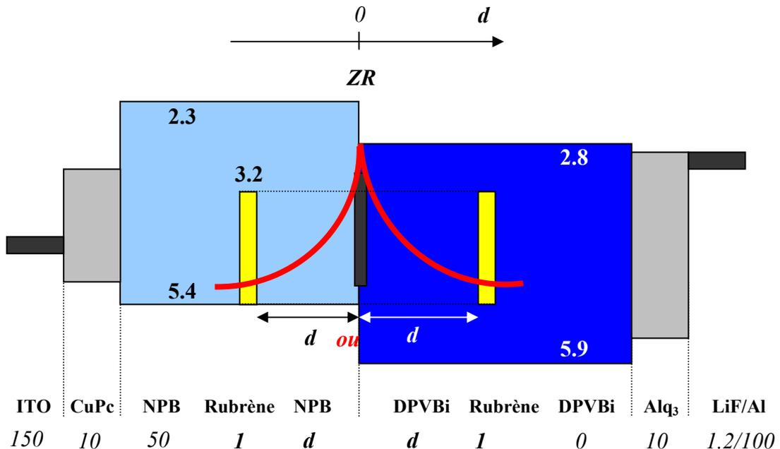
**Figure III.3:** Structure de l’OLED utilisée pour la détection des excitons singulets. Les épaisseurs des couches sont en nanomètres. NB : la couche de Rubrène est placée soit à  $d < 0$  soit à  $d > 0$ , jamais les deux.
