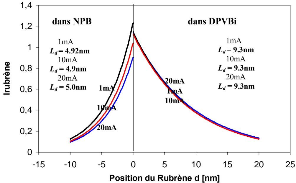
**Figure III.5 :** Effet du courant sur la longueur de diffusion des exciton singulets  $L_d$ .
