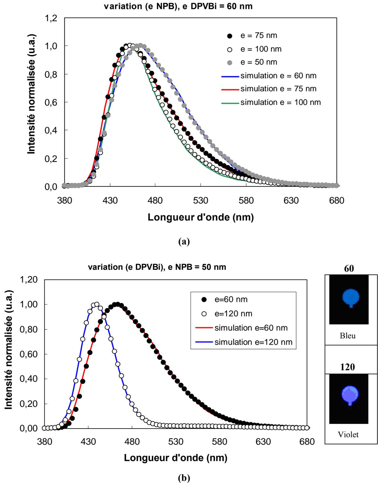
**Figure II.11** : En (a), intensité normalisée des spectres simulés et spectres expérimentaux pour différentes épaisseurs de NPB. En (b), les mêmes spectres pour différentes épaisseurs de DPVBi avec les images des OLEDs correspondantes.
