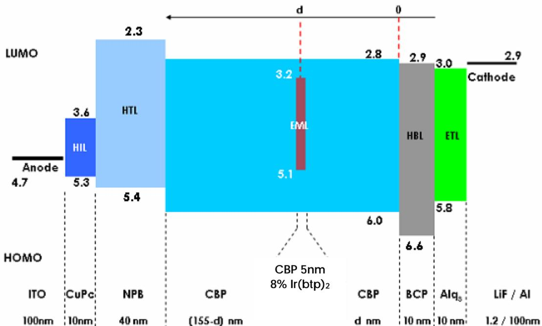
**Figure III.12** : Structure utilisée pour déterminer la longueur de diffusion des triplets  $L_d$ .
