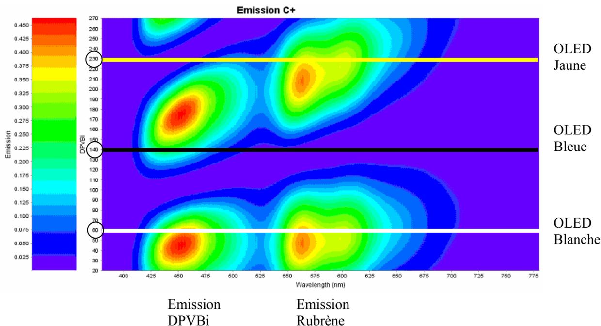
ETFOS prévoit une variation de la couleur d'émission de l'OLED qui passe du blanc pour  $x = 60$  nm, au jaune pour  $x = 230$  nm avec un point intermédiaire  $x = 140$  nm correspondant à une émission bleue. Ces variations de couleurs sont dues à l'effet de microcavité, et selon l'épaisseur du DPVBi, l'épaisseur totale de l'OLED varie et les champs optiques respectifs du bleu et du jaune varient.
