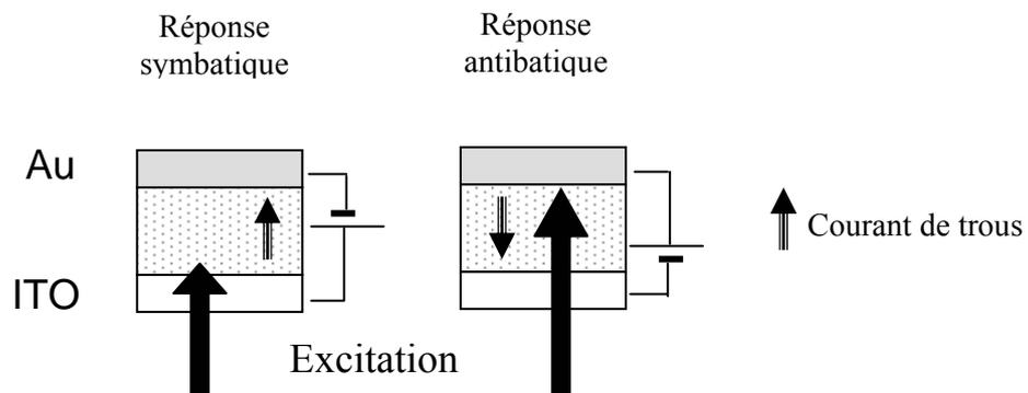
**Figure III.6:** Schéma de principe de l'expérience de mesure de photocourant en régime stationnaire. A gauche, l'ITO est polarisé positivement, les trous photogénérés parcourent le matériau jusqu'à l'or : le photocourant est proportionnel à l'absorption ; à droite, l'ITO est polarisé négativement, le courant de trou observé provient d'excitons qui se sont dissociés au voisinage de l'électrode d'or : le photocourant n'est plus proportionnel à l'absorption.
