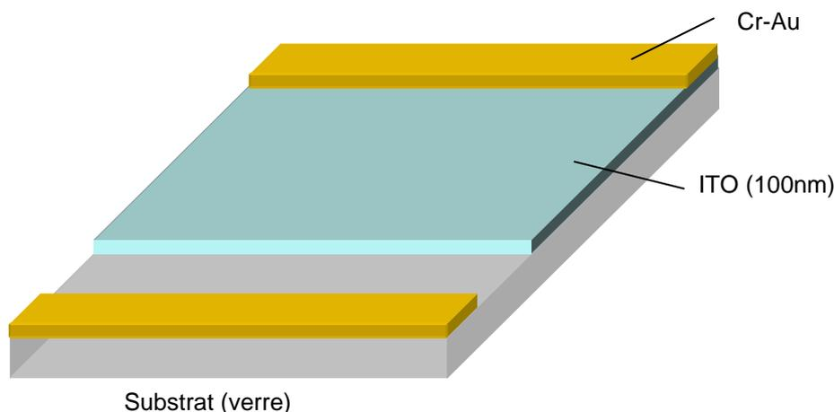
Schéma du substrat avec les contacts.
