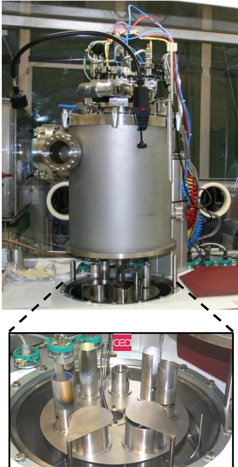
**Figure II.2 :** Cloche du bâti d'évaporation en haut, et intérieur du bâti avec 6 creusets organiques et 2 creusets métalliques en bas.
