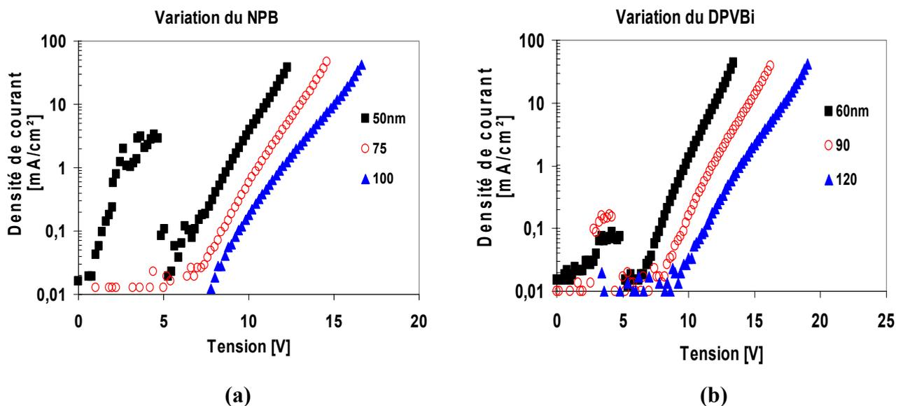
**Figure II.12 :** Densité de courant en fonction de la tension pour les variations d'épaisseur du NPB (a) à épaisseur de DPVBi (60 nm) constante, et pour les variations d'épaisseur du DPVBi (b) à épaisseur de NPB (50 nm) constante.
