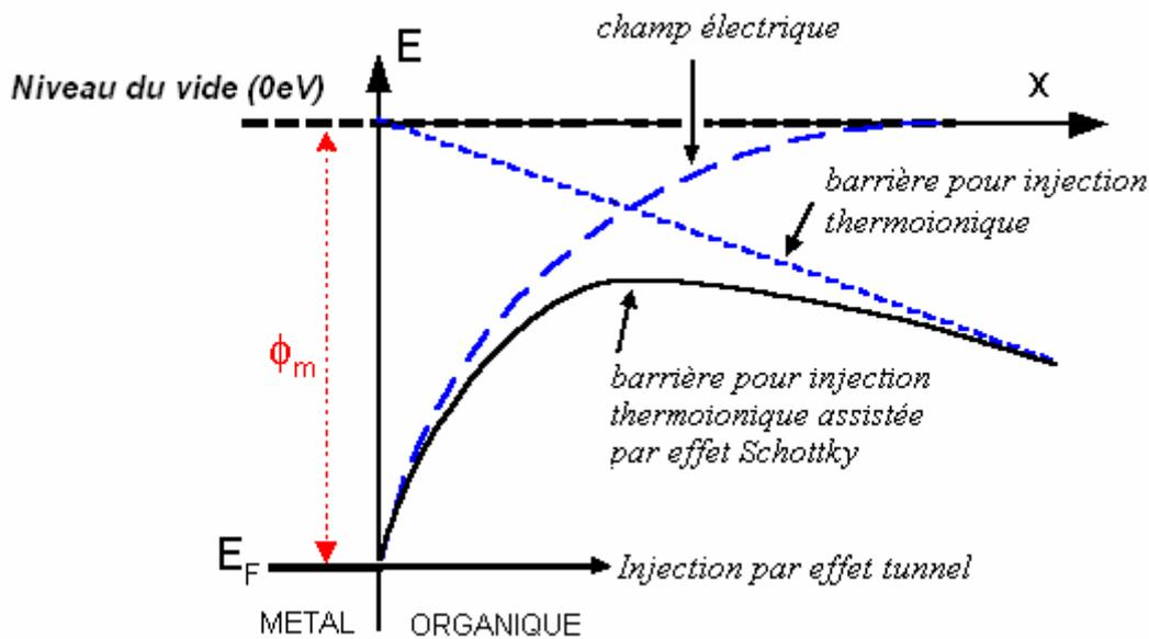
**Figure I.4 :** Différents mécanismes d'injection depuis une électrode.
