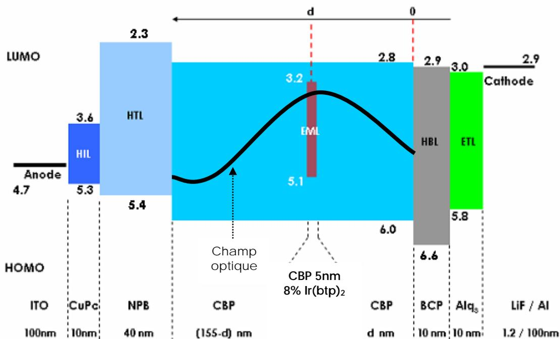
**Figure III.17 :** Structure de l'OLED envisagée pour la mesure de la diffusion des triplets du CBP, avec le champ optique de l'émission rouge d'Ir(btp)<sub>2</sub> (*acac*).
