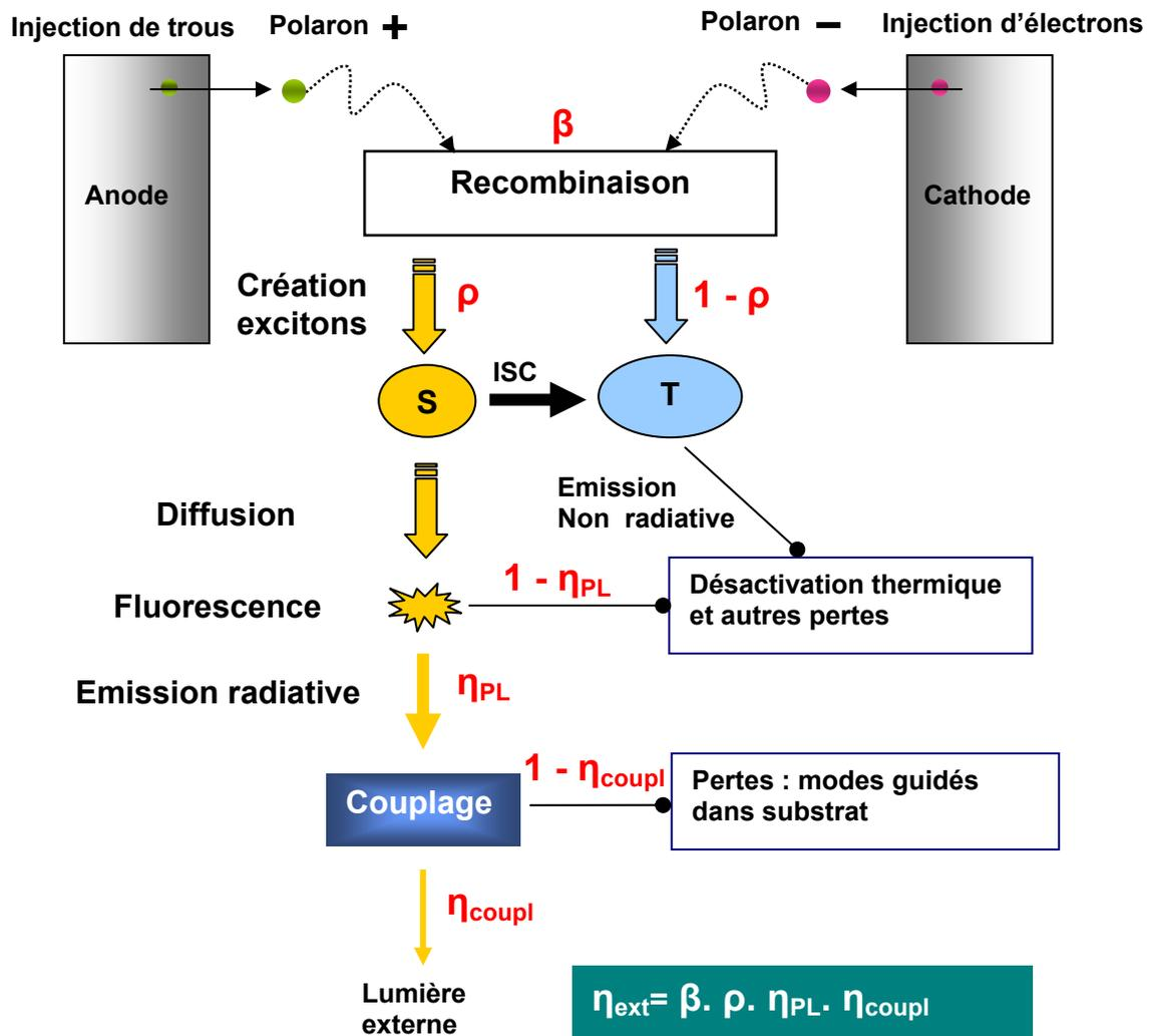
**Figure I.10.** Représentation schématique des processus élémentaires intervenant dans une OLED fluorescente. On a représenté notamment la recombinaison des charges, la création des excitons, l'émission de lumière jusqu'au rendement de la lumière externe.
