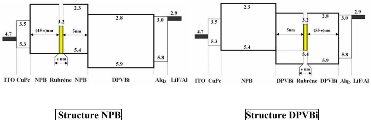
**Figure II.14** : Les deux structures utilisées pour l'effet de l'épaisseur de la couche de Rubrène dans les matrices NPB et DPVBi.
