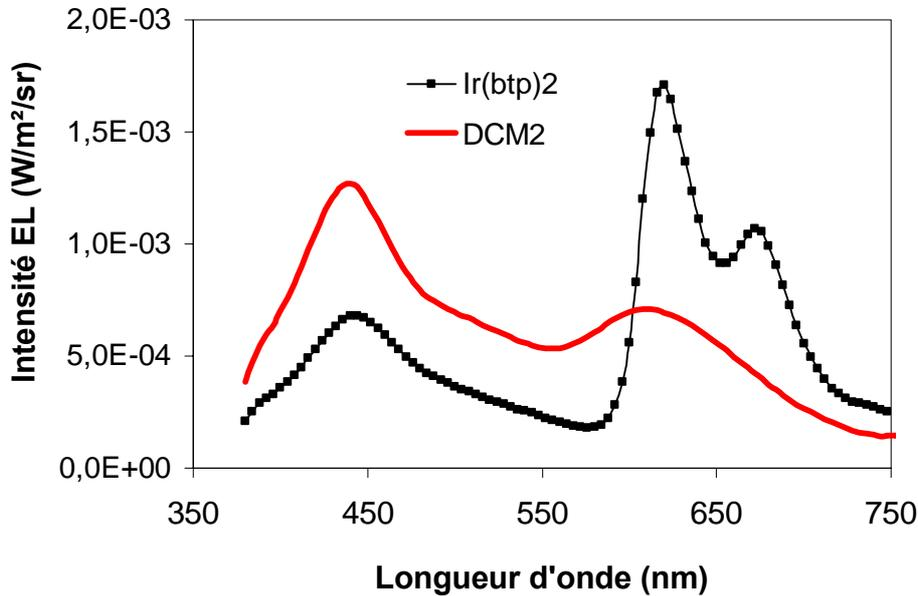
**Figure III.26** : Spectres d'électroluminescence (EL) de l'OLED optimisée pour 5 nm de CBP dopée soit par 8 % d'Ir(btp)<sub>2</sub> ou par 1.7 % de DCM2 pour  $d = 12.5$  nm à  $J = 15$  mA/cm<sup>2</sup>.
