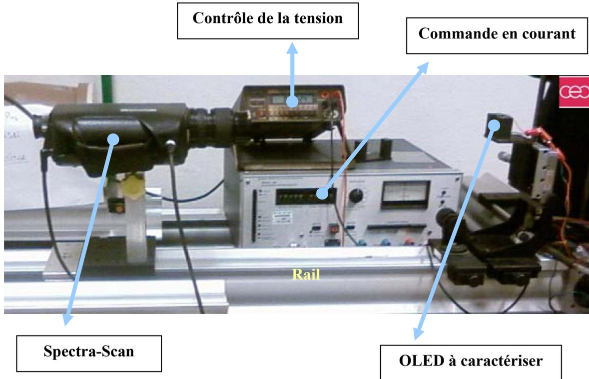
Le Spectra-Scan PR-650 est muni d'une lentille « zoom » de focale variable permettant de faire varier la mise au point sur la surface émettrice. La surface de mesure est alors définie par l'appareil comme il est indiqué sur la figure suivante.
