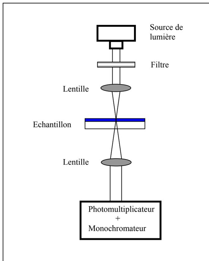
Montage du spectrofluorimètre pour la mesure de PL. L'excitation définie par l'utilisateur est monochromatique.
