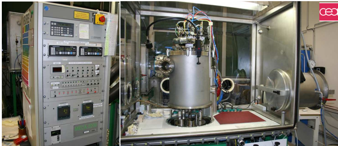
Boîte à gants N 2 contenant un sas (à droite), un espace de travail, la cloche et les creusets.
