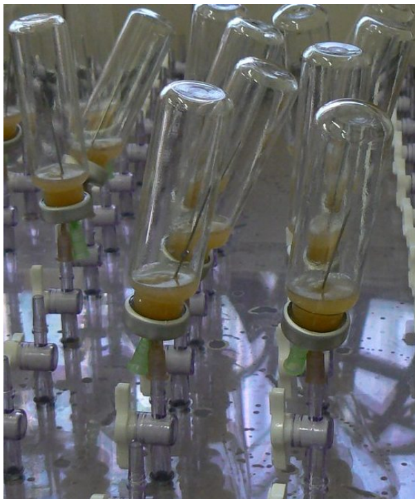
Figure 5.7 – Dégazage des solutions bactériennes avant injection des échantillons de nitrate.
