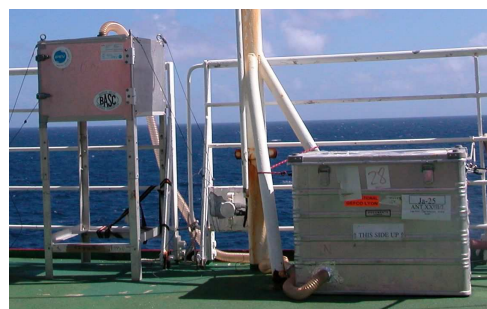
(b) Photographie du collecteur haut-volume, en opération sur le Polarstern en Avril 2007
