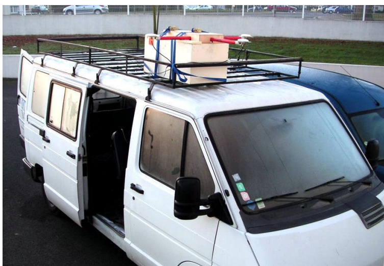
FIG. 4.2 – Vue de la camionnette transportant le système Limo-G. On distingue le réseau des quatre antennes du récepteur ADU2.
