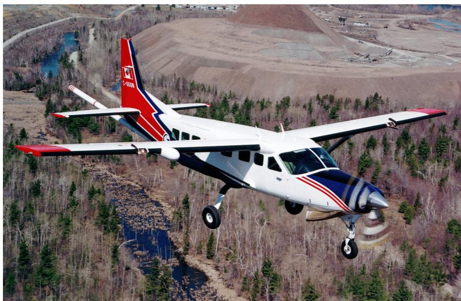
FIG. 1.15 – Cessna 208B Grand Caravan utilisé pour les levés de gravimétrie mobile à l'aide du système AIRGrav (FERGUSON et HAMMADA 2000).
