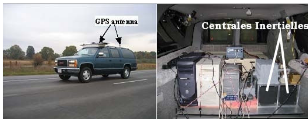
FIG. 1.17 – Vues du système développé par l’université d’état de l’Ohio (JEKELI et LI 2006). À gauche le véhicule porteur et à droite, l’instrumentation embarquée, notamment les centrales inertielles Honeywell H764G.
