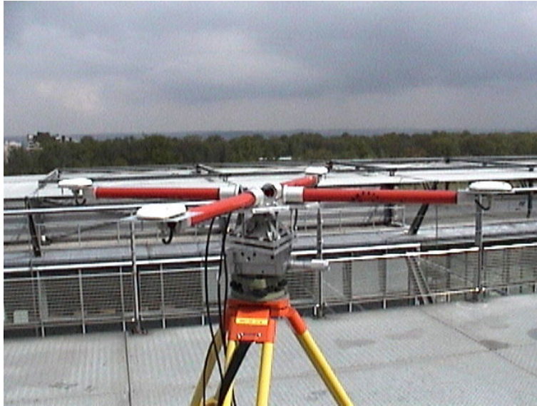
FIG. 3.7 – Vue des quatre antennes du récepteur GPS ADU2 lors de l'étalonnage géométrique sur le toit de l'ENSG.
