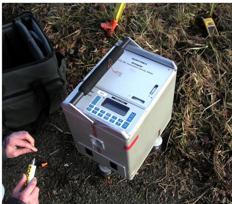
FIG. 4.3 – Vue du gravimètre Scintrex CG-3M Autograv de l'IPGP.
