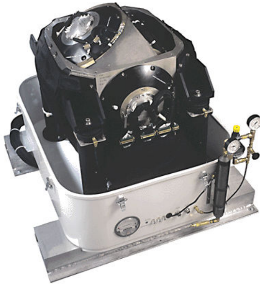
FIG. 1.20 – Vue du système « Three Dimensional Full Tensor Gradient » (3D-FTG). © Bell Geospace, USA.
