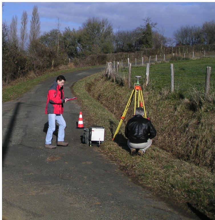
FIG. 4.4 – Installation du pivot sur le point gravimétrique n°1.
