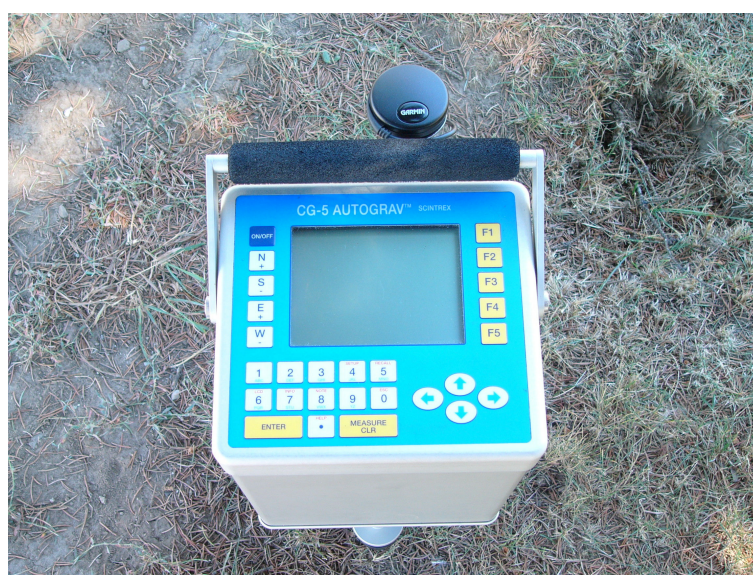
FIG. 1.6 – Gravimètre relatif à peson du type CG-5. © Micro-g Lacoste Inc.
