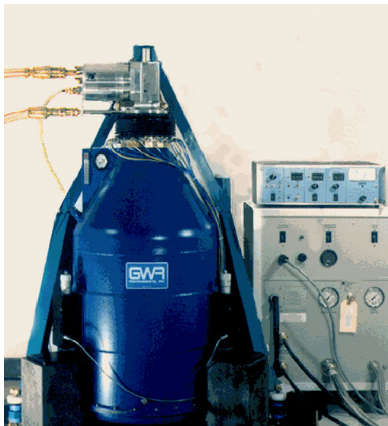
FIG. 1.7 – Gravimètre à supraconducteur dans son enceinte cryogénique. © GWR Instruments Inc.
