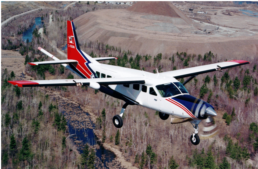
FIG. 1.15 – Cessna 208B Grand Caravan utilisé pour les levés de gravimétrie mobile à l'aide du système AIRGrav (FERGUSON et HAMMADA 2000).
