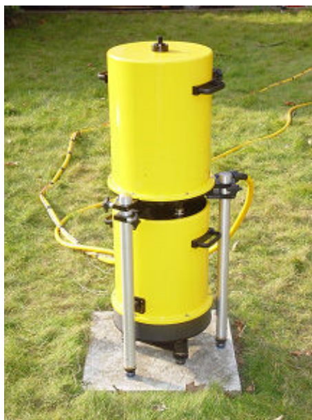
FIG. 1.8 – Gravimètre absolu balistique de type A10 utilisé par l'IGN. © Photo J. Verdun.
