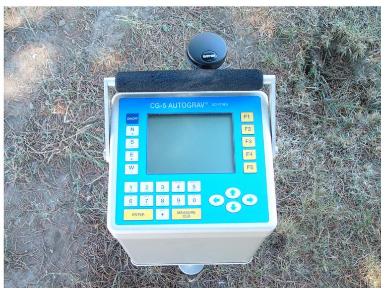
FIG. 1.6 – Gravimètre relatif à peson du type CG-5. © Micro-g Lacoste Inc.
