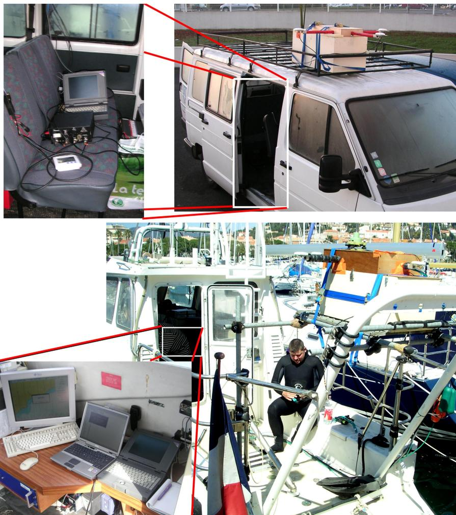
FIG. 3.11 – Montages possibles sur véhicule terrestre ou marin réalisés avec le système Limo-G.
