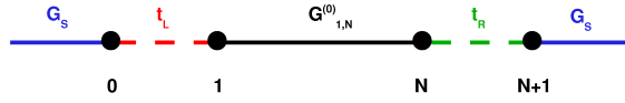
FIG. 2.3 – Représentation de la fonction de Green non diagonale G_{0N+1}(E) pour une chaîne 1D à N atomes connectée à deux électrodes non parfaites. A l'ordre non nul le plus bas(ordre 2), la fonction de Green correspond à une transmission directe de la gauche vers la droite à travers la cavité.
