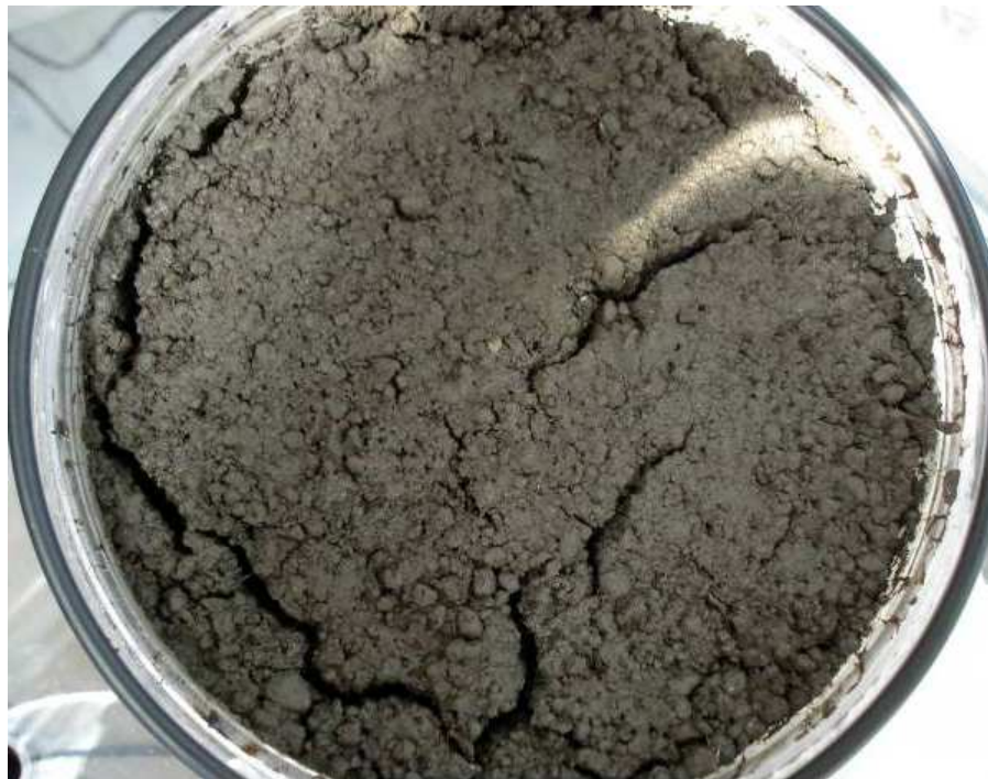
Figure D-58 : Fissuration de l'horizon de surface sous l'influence des alternances d'évènements pluvieux (Colonne 2, lors de son sacrifice)
