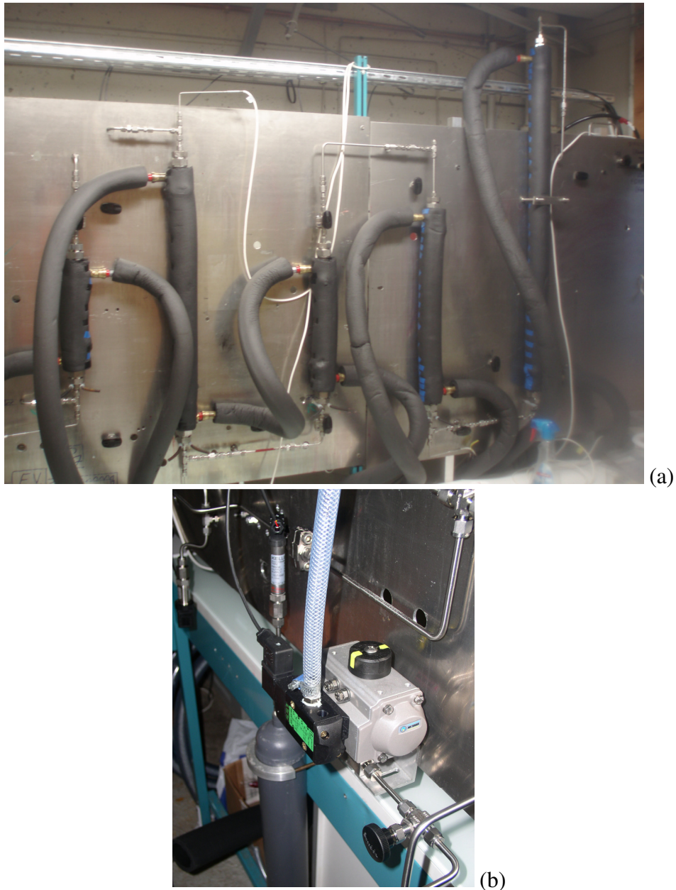
Image 6.2 – (a) Dispositif expérimental, (b) Système de dissociation des hydrates de méthane
