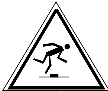
FIG. 1.3: panneau d'avertissement : risque de trébuchement
