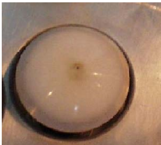
Figure 57 : Perforation du revêtement dans le cas du SF_6 .
