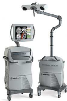
FIG. 1.4 – Système de neuronavigation StealthStation TREON Medtronic. A gauche : l'unité centrale où les images du patient sont stockées. A droite : le système de localisation composé de deux caméras infrarouges.
