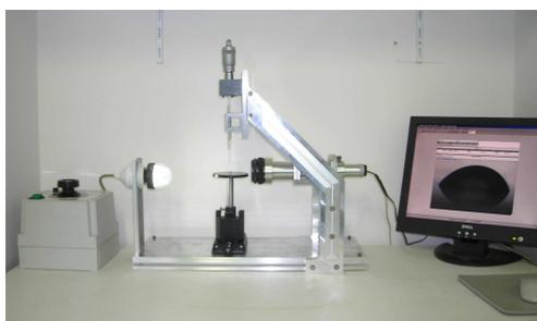
Figure III.5 : Montage expérimental de mesure d'angle de goutte.
