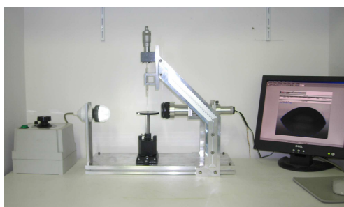
Figure III.5 : Montage expérimental de mesure d'angle de goutte.
