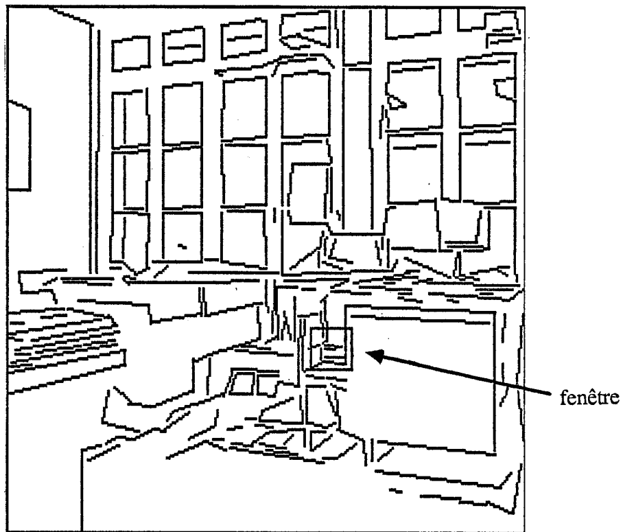
Figure 2.26: Les segments de droite extraits de l'image précédente. La fenêtre sur cette figure, est la fenêtre que nous avons agrandie sur la Figure 2.24 et à l'intérieur de laquelle nous avons détaillé le résultat du groupement.
