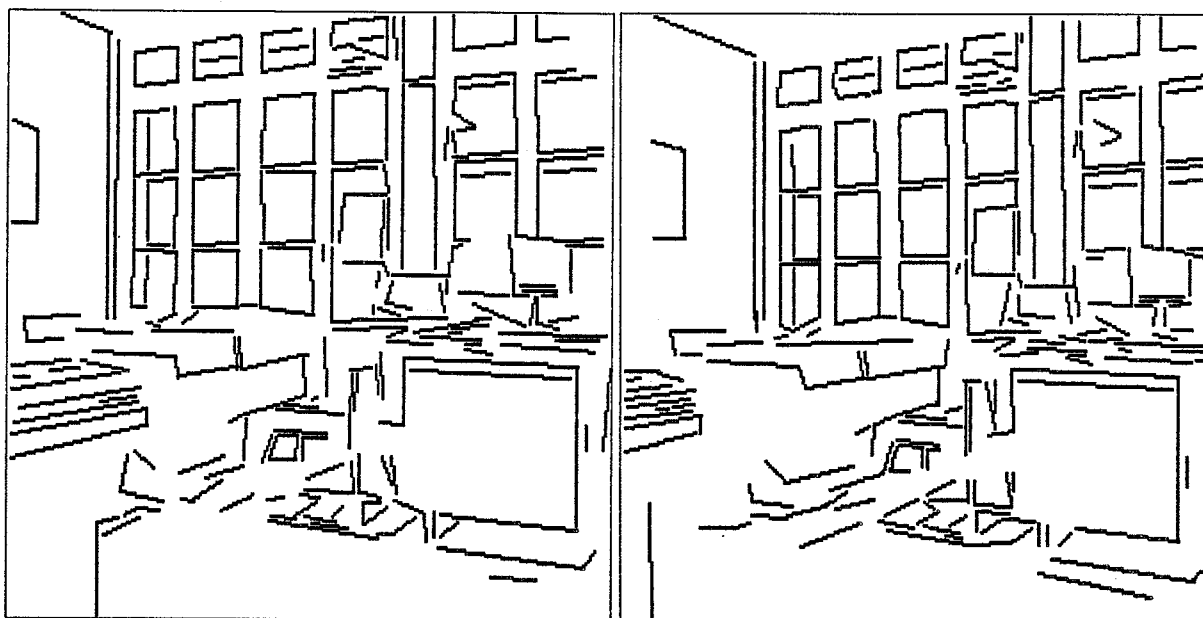
Figure 3.28: Le résultat de l'appariement des segments extraits de la première paire d'images.
