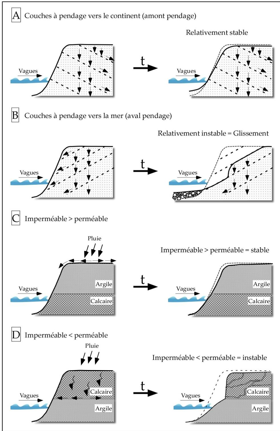
Figure 22 : Influence du pendage des couches (A-B) et de la lithologie (C-D) sur le développement des falaises littorales (d'après French, 1997, modifié). La flèche et la lettre *t* indiquent l'évolution dans le temps de la falaise côtière en fonction des différents paramètres.
