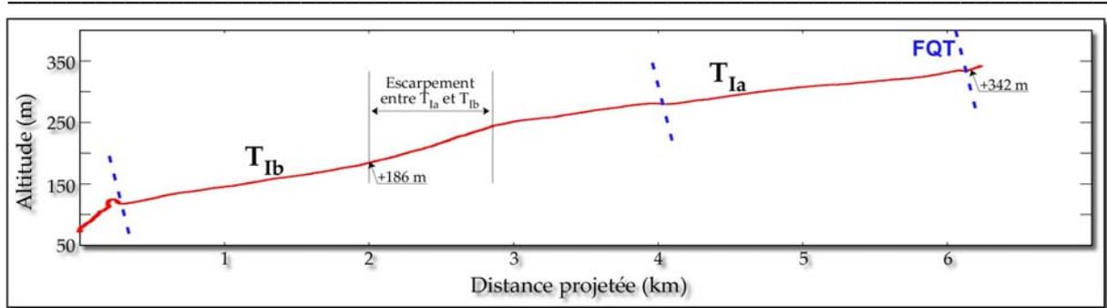
Figure 47 : Profil GPS cinématique de la Caleta Maïten (Cf. Figure 46 A' pour la localisation du profil). Les traits en pointillés bleus indiquent le tracé des failles. FQT : Faille Quebrada del Teniente.
