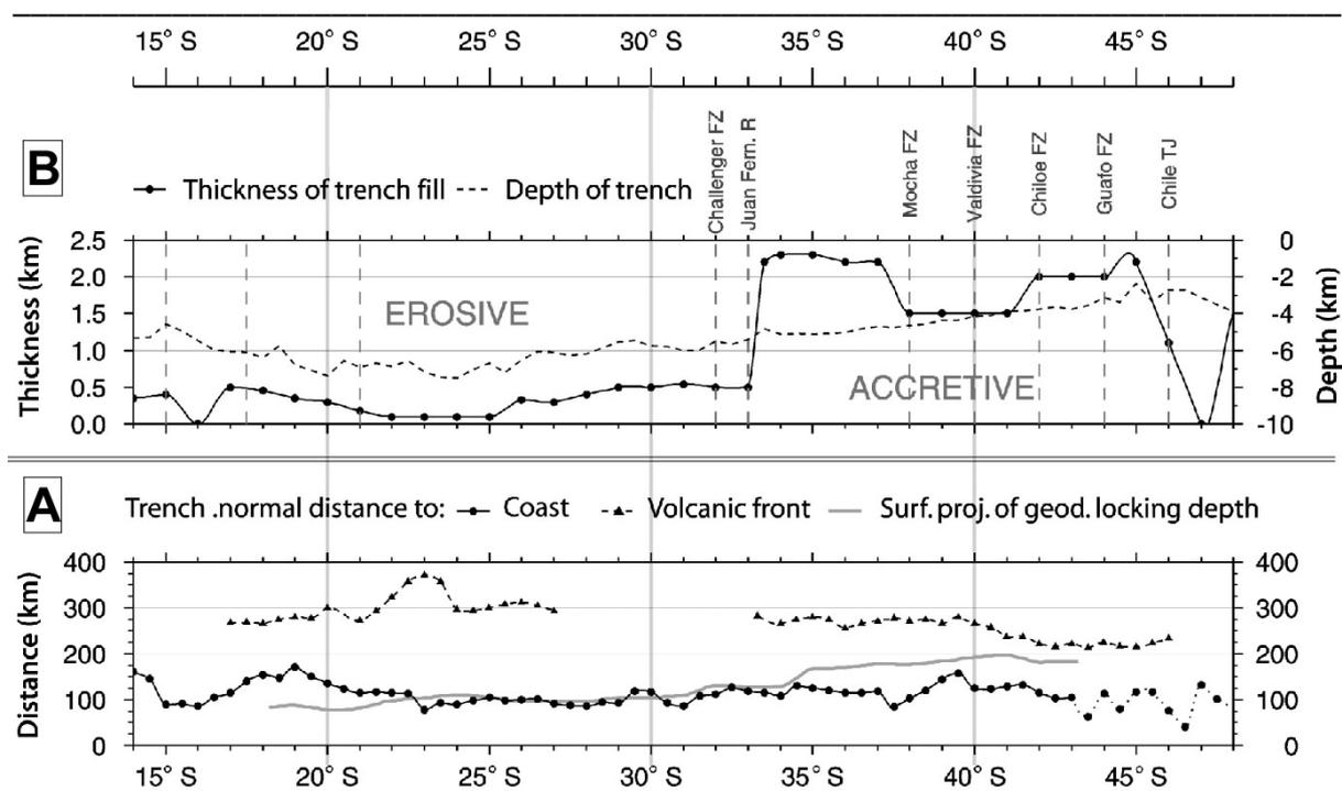
Figure 90 : A - Relations entre la distance fosse-côte et la projection en surface de la profondeur de la zone bloquée en fonction de la latitude. B – Relation entre l'épaisseur sédimentaire au niveau de la fosse et la latitude, ainsi que le mode de transfert de masse de la marge andine (Erosion ou accrétion ; modifié d'après Hoffmann-Rothe et al., 2006).
