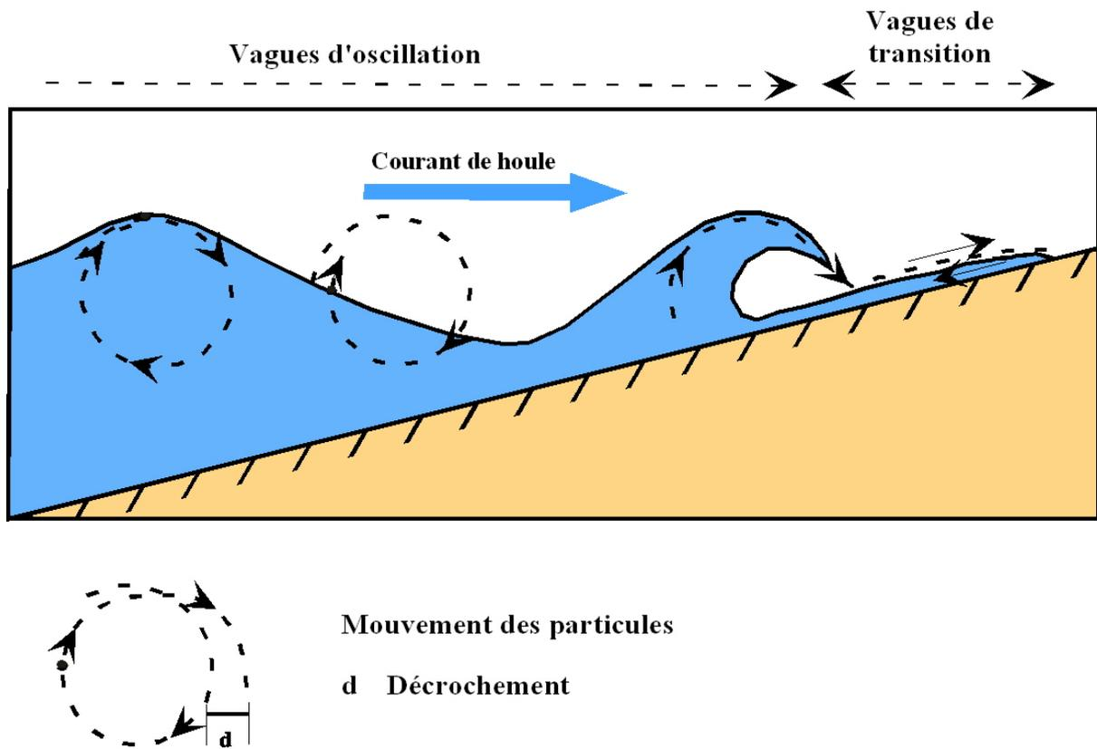
Figure 11 : Mouvement des particules dans les vagues, modifié d'après Derruau, 1974.
