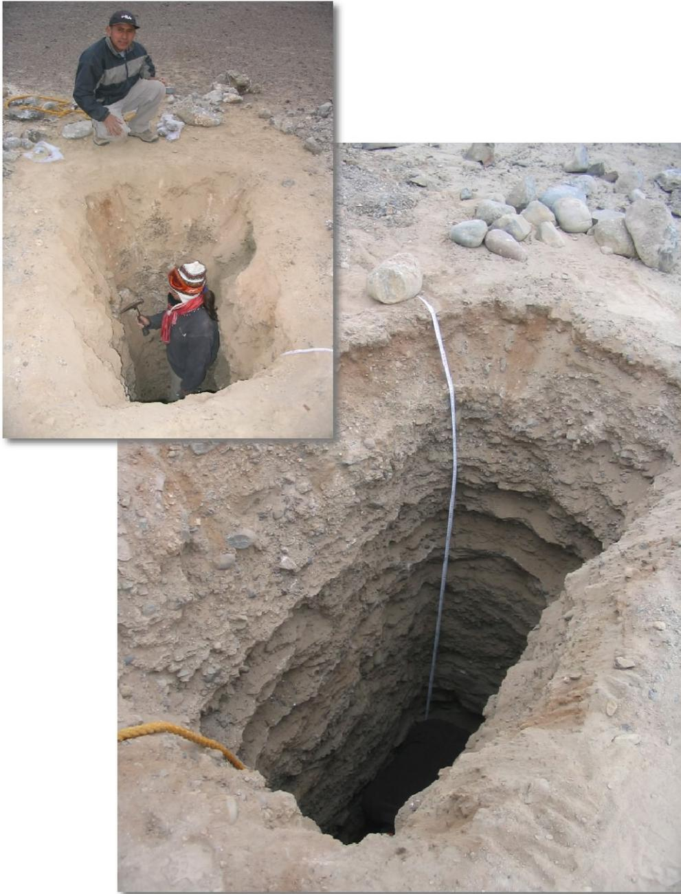
Figure 33 : Photographies d'un échantillonnage d'une terrasse marine de dépôts le long d'un profil en profondeur (Chala, Pérou). Pour réaliser cet échantillonnage, nous avons creusé des fosses d'environ 2 m de profondeur dans la terrasse et échantillonné des galets prélevés à différentes profondeurs.
