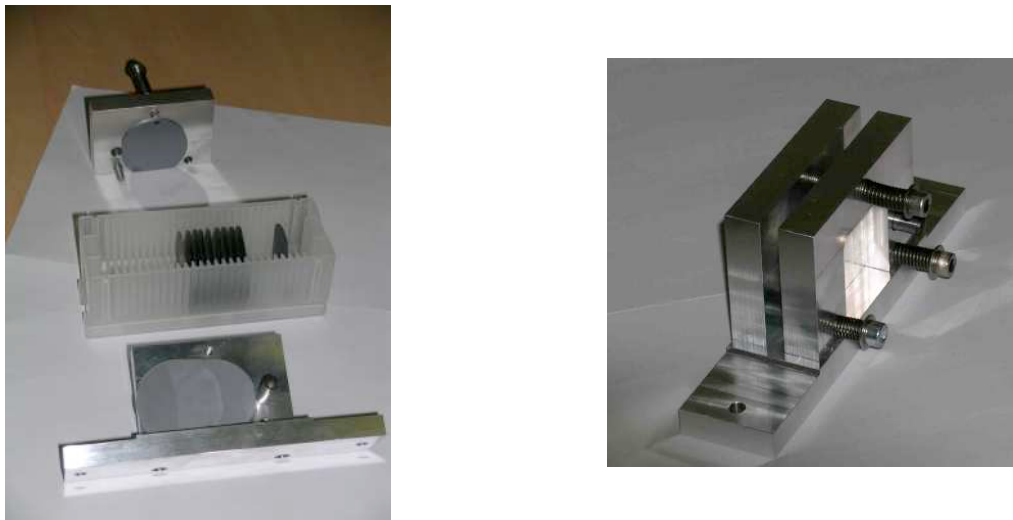
FIG. 4.11: Wafers de silicium en cours d'empilement dans leur support en aluminium. Le support a été dessiné à l'ILL par Bernard Hamelin. Il comprend trois vis de serrage avec ressorts, et les deux cotés sont évidés au niveau des wafers pour limiter l'absorption lors des mesures aux rayons X.
