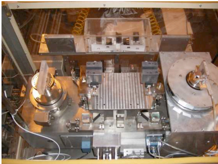
FIG. 5.6: Vue de l'interféromètre de GAMS 4. Dans l'ordre de traversée par le faisceau se trouve, sur le goniomètre de gauche, le cristal de quartz, puis les deux fentes, puis sur le goniomètre de droite qui accueille notre porte échantillon aspirant.
