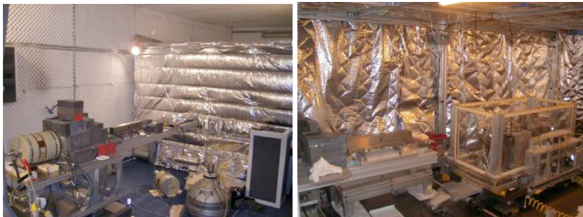
FIG. 5.5: A gauche : détecteur HPGe caché sous son château de plomb et relié à son réservoir d'azote liquide, en face d'un collimateur et de la 'tente' isotherme abritant la table de l'interféromètre. A droite : A l'intérieur de la 'tente', la table de l'interféromètre et un collimateur. Sur cette image, le faisceau arrive de la droite.
