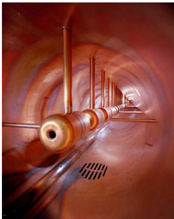
(a) Cavités radio-fréquence constituant le linac (accélérateur linéaire).
