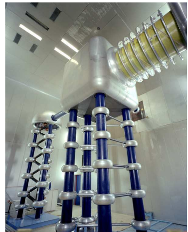
(b) Pré-accelérateur Cockcroft-Walton. On distingue le dôme contenant la source Magnetron et la colonne où sont accélérés les ions H^- .
