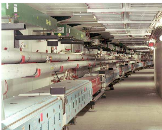
FIGURE 3.6 – Photo de l'intérieur du tunnel de l'injecteur principal (aimants bleus, en bas) abritant le recycleur (aimants verts, en haut).
