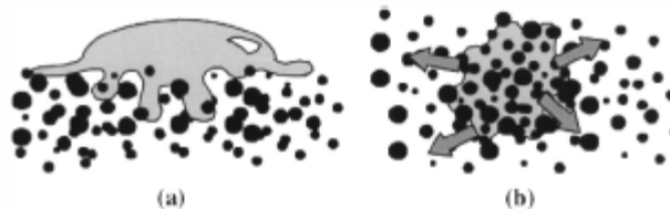
Figure 1. 5. Formation d'un nucleus (a) imbibition du liquide au sein du milieu, (b) migration du liquide au sein du milieu (Iveson et al. , 2001)
