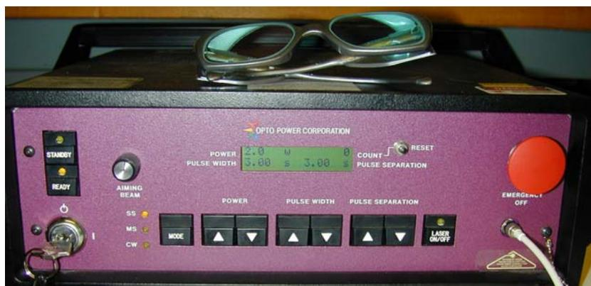
Figure 24: Système diode-laser 815 nm
