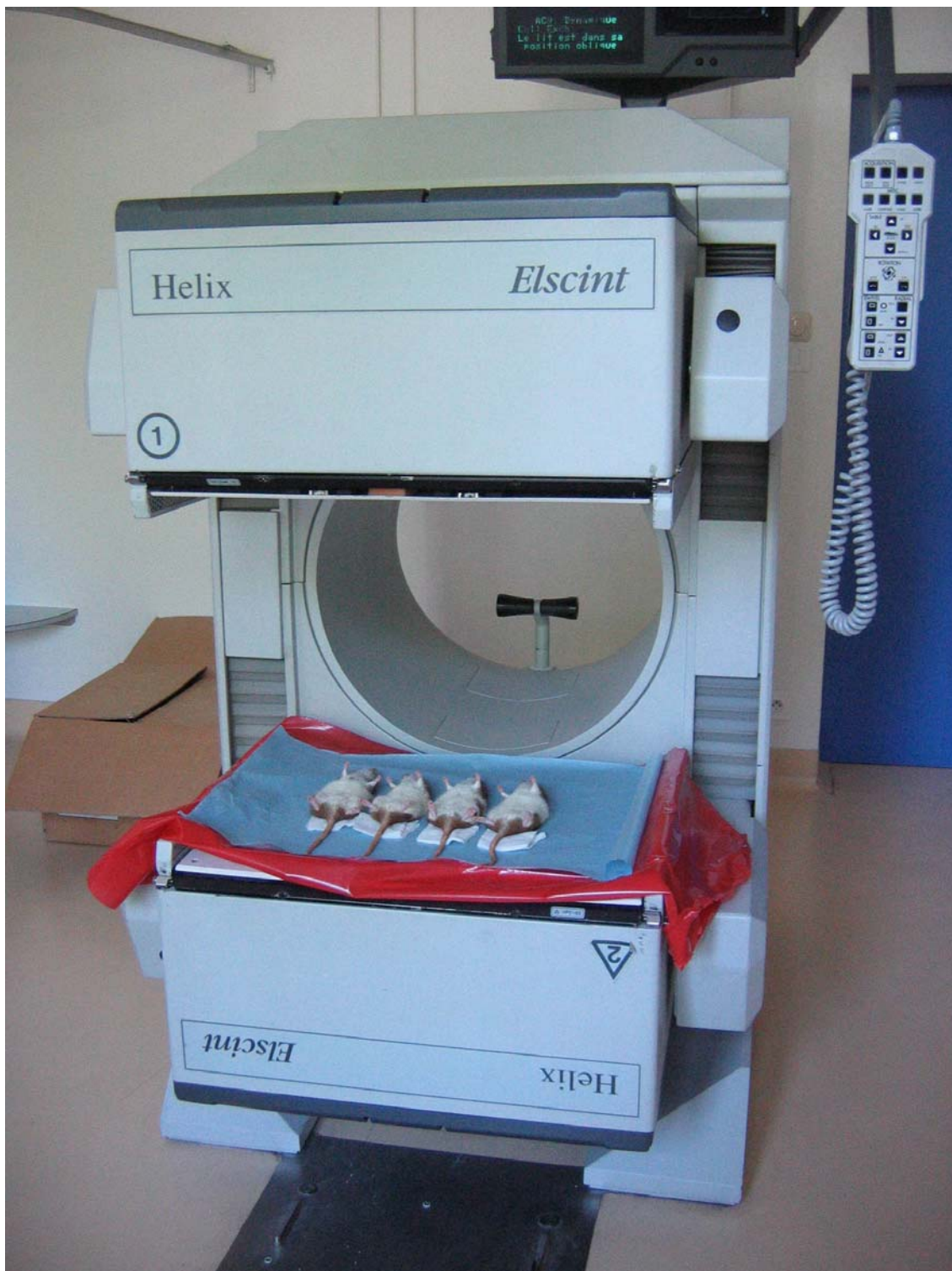
Figure 6 : Gamma-caméra Elscint Hélix utilisée lors de la scintigraphie
