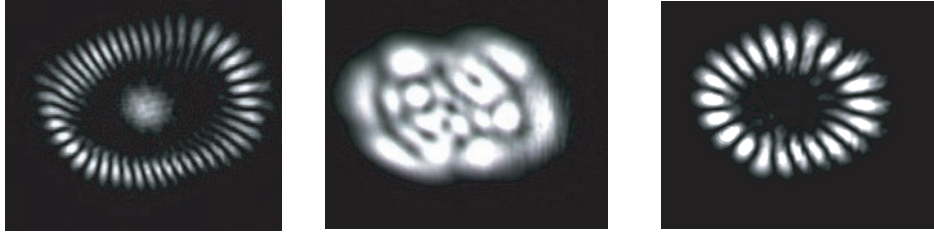
FIG. 4.23 – Quelques exemples des modes transverses capturés sur camera CCD. Ils peuvent être très différents l'un de l'autre, la différence étant probablement due à une mauvaise stabilité mécanique de l'ensemble du système (cavité et stabilité de l'alignement de faisceaux pompes non asservis). Les modes aux allures de pétales viennent d'une superposition deux modes de Laguerre-Gauss [119].
