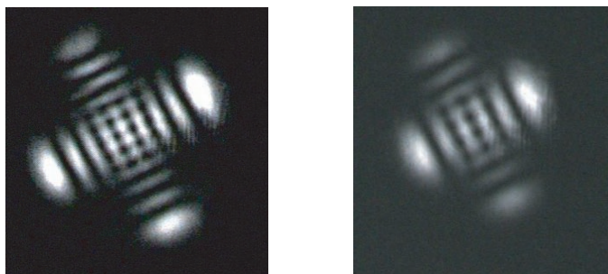
FIG. 4.19 – deux exemples des modes transverses du laser raman. Il s'agit d'une superposition de modes d'Hermite-Gauss TEM_{08} , TEM_{011} , etc... [117]. Une symétrie rectangulaire est ici favorisée.
