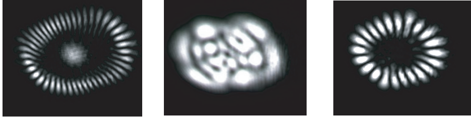
FIG. 4.23 – Quelques exemples des modes transverses capturés sur caméra CCD. Ils peuvent être très différents l'un de l'autre, la différence étant probablement due à une mauvaise stabilité mécanique de l'ensemble du système (cavité et stabilité de l'alignement de faisceaux pompes non asservis). Les modes aux allures de pétales de fleur viennent d'une superposition deux modes de Laguerre-Gauss, et sont typiquement dus à la présence d'un mécanisme à conjugaison de phase [122, 123].
