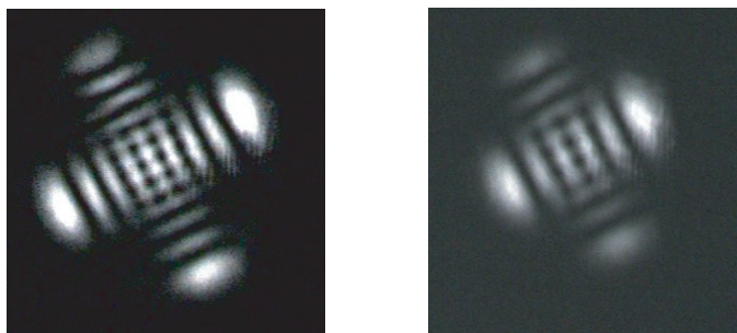
FIG. 4.19 – deux exemples des modes transverses du laser Raman. Il s'agit d'une superposition de modes d'Hermite-Gauss TEM_{08} , TEM_{011} , etc... [120]. Une symétrie rectangulaire est ici favorisée.
