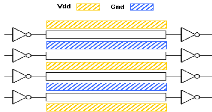
Figure I-25 : Illustration de la technique de blindage des lignes d'interconnexion.
