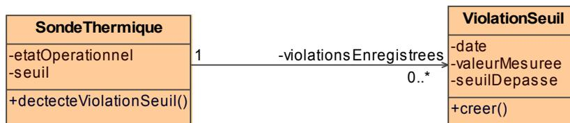
Un objet *SondeThermique* surveille la température courante d'une sonde dans le but de détecter des violations de seuil. Pour faire son travail, l'objet *SondeThermique* doit connaître ses états opérationnels et son seuil. Lorsqu'il détecte qu'une violation de seuil est survenue, il envoie un message à la classe *ViolationSeuil* pour créer une nouvelle instance de cette classe avec les valeurs de date et d'heure, la valeur mesurée et le seuil de détection.
