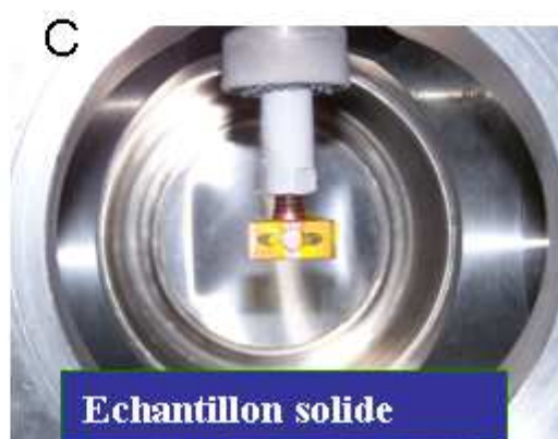
Figure 33 Environnement échantillon des mesures XANES réalisées sur la ligne BM30b de l'ESRF. A : vue d'ensemble, B : Vue d'un échantillon liquide agité, C : Vues d'un échantillon solide.
