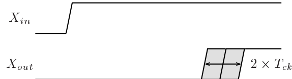
FIG. B.2 – Le décalage est incorrect. L'épaisseur du trait sur les fronts du signal de sortie est de deux périodes d'horloge.
