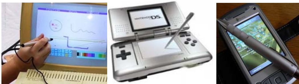
Figure 9 Dispositifs de pointage direct : crayon optique du TO8, stylet sur Nintendo DS et stylo-stylet de PDA
