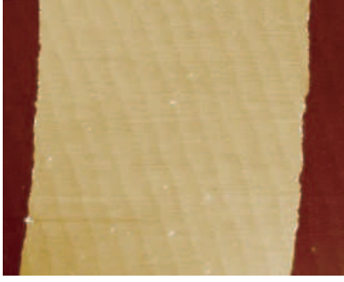
FIGURE 4.1 – Image AFM en hauteur d’une piste de Nb 5\mu\text{m} de large. La piste est obtenue par lithographie optique avec le procédé de masquage aluminium (annexe). La micrographie discerne des terrasses et des marches de 0.3\text{nm} de hauteur. La surface vicinale du saphir est répliquée lors de l’épitaxie du film. La surface de la piste de Nb est atomiquement propre.
