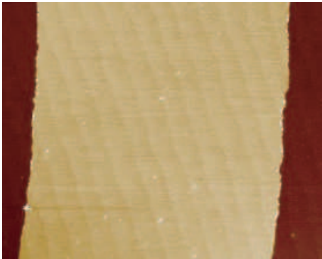
FIGURE 1 – Image AFM en topographie d'une piste de niobium de 5\mu\text{m} de large et de 10\text{nm} d'épaisseur. Les surfaces vicinales du saphir sont répliquées à la surface du niobium.
