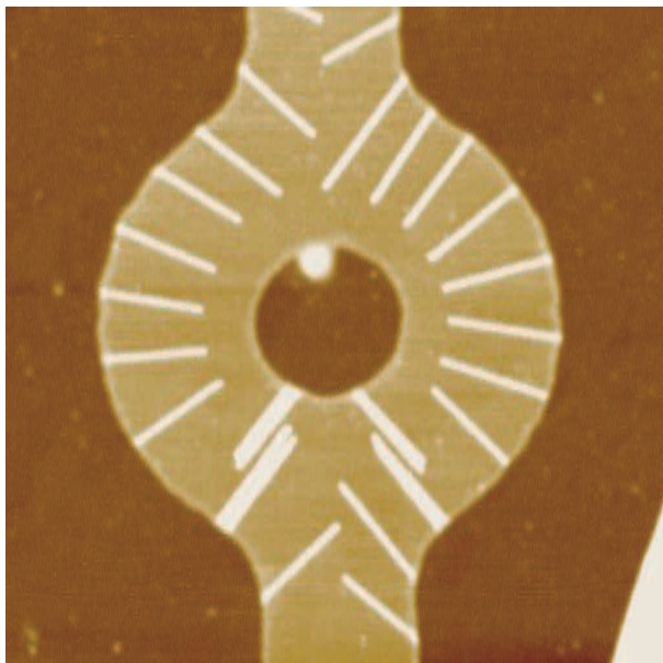
FIGURE 4.4 – Image AFM ( 5\mu\text{m} \times 5\mu\text{m} ) en hauteur, d'un SQUID de Nb à ponts longs. Le SQUID est lithographié par AFM sur un film de 3nm d'épaisseur. Sa largeur est de 30nm et sa longueur de 200nm. Les tracés d'oxyde, perpendiculaires au passage du courant, permettent de diminuer le bruit de flux qui élargit les histogrammes du courant d'échappement.
