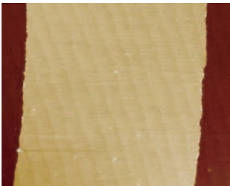
FIGURE 2.8 – Image AFM en hauteur d'une piste de niobium de 5\mu m de large et de 10nm d'épaisseur. Les surfaces vicinales du saphir sont répliquées à la surface du niobium.
