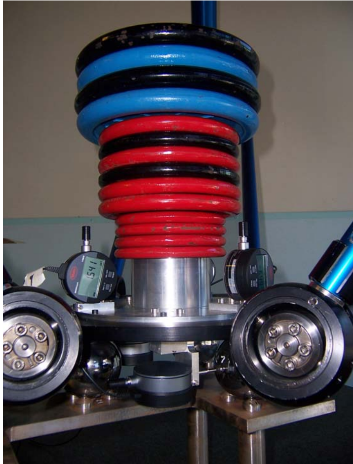
Figure 3.13 – Mesure expérimentale des déformations élastiques de la structure Delta.
