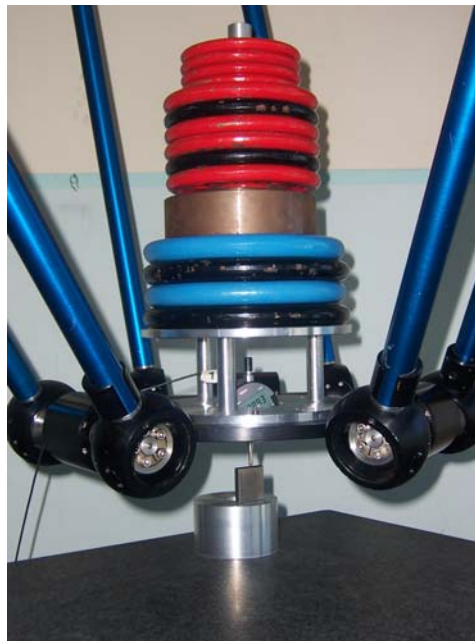
Figure 4.13 – « Mesure du défaut de planéité du marbre »
