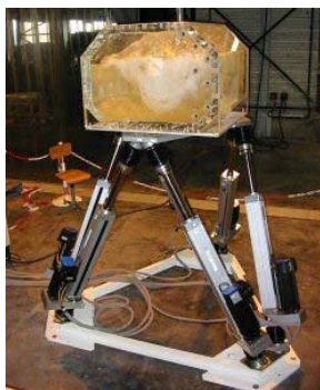
Figure 1.6 – Simulateur de houle MISTRAL (Symétrie, ECN)
