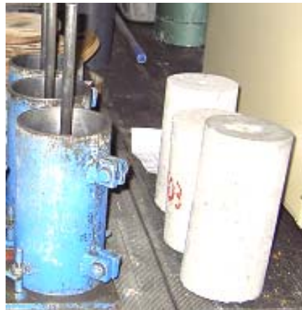
Figure 2.2 : Moules métalliques avec des barres.
