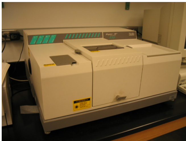
Fig. 6 : Spectromètre Nicolet Magna 550.
