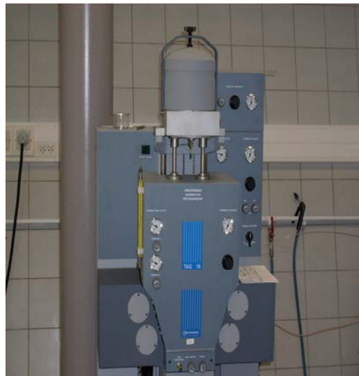
Fig. 8: Appareil ATD-ATG SETARAM-TAG16
