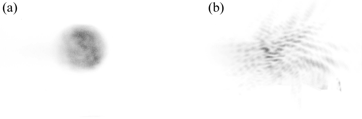
Fig. 3.3: Profil spatial du laser LUCA après réflexion sur le plasma pour deux éclaircements. En (a) l'éclairement est de 4 \times 10^{16} W cm^{-2} , en (b) de 7 \times 10^{17} W cm^{-2} .
