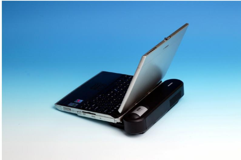
figure 4.11 : La pile à méthanol direct développée par Toshiba [95].
