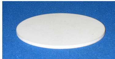
figure 2.12 : Disque poreux en céramique frittée
