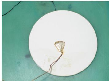
figure 2.19 : Technique de mesure de la tension appliquée aux bornes du disque poreux.
