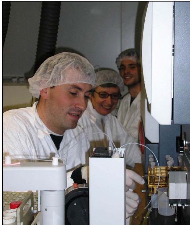
Figure IV.6 : Photographie illustrant le passage manuel des échantillons à l'ICP/AES dans le cas présent, deux personnes sont nécessaires (Photographie : C. Churlaud).
