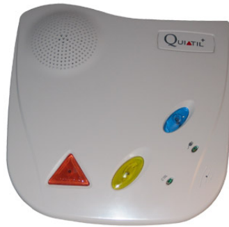
FIG. 2.3 – Exemple de la base Quiatil+ d'Intervox, avec ses trois boutons simples d'utilisation : Urgence, appel d'un proche, appel des services à domicile
