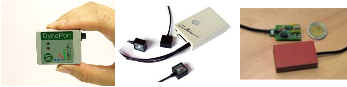
FIG. 2.1 – Centrales de mesures. De gauche à droite : Dynaport de Mc Roberts, Physilog du LMAM, Trident du CEA-LETI
