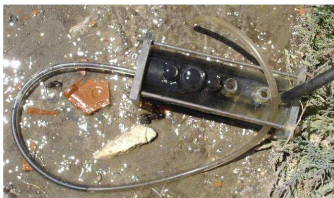
**Fig. 74. Dépôts noirs laissés par l'eau du piézomètre S<sub>1</sub> dans la cellule de mesure**
