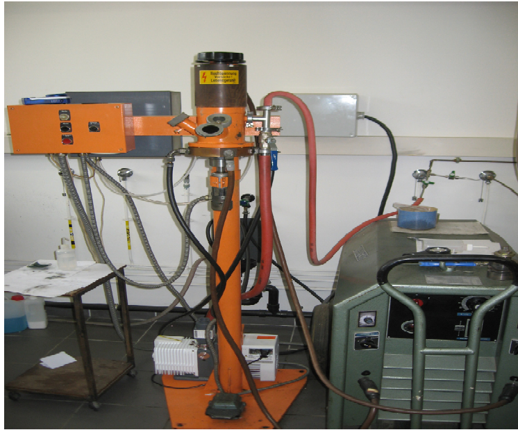
Fig. 45 Photographie du four à arc
