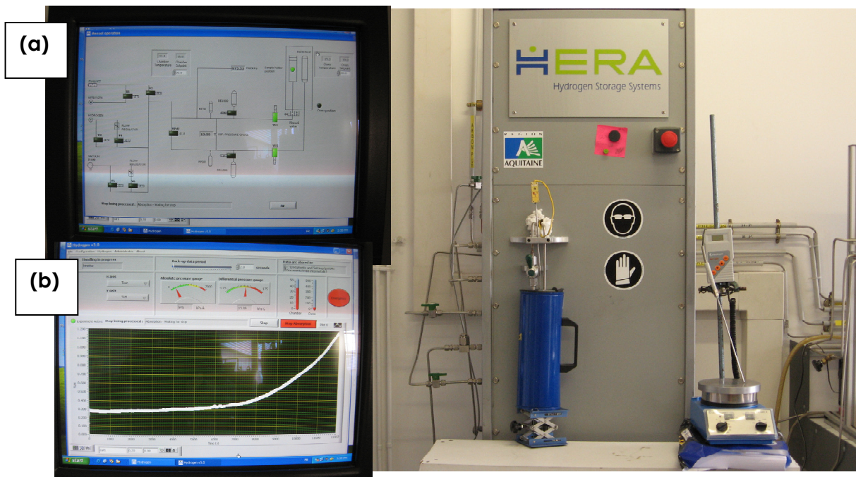
Fig. 47 Photographie de l'appareil volumétrique d'hydruration de type Sievert (HERA) ((a) schéma de principe de l'appareil ; (b) exemple de courbe cinétique obtenue)
