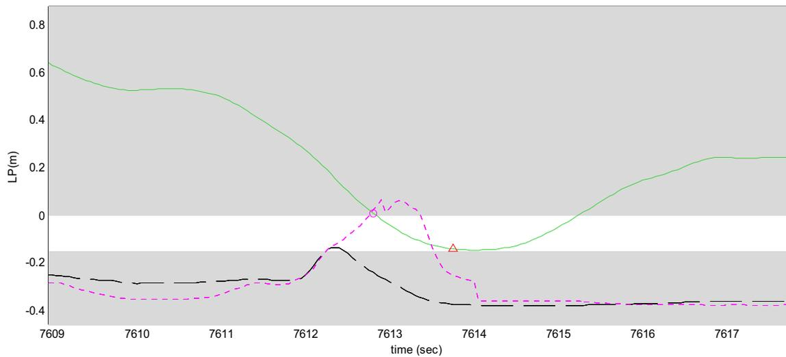
Figure IV.26 : Le VRBS<sub>2</sub> (ligne en tiré court), comparé à l'évolution du VRBS<sub>1</sub> (ligne en tiré long), génère un avertissement (cercle) pour le conducteur C3. Il n'y a pas d'avertissement du vibreur à 0.15 m. mais une détection du *tlc* (triangle).
