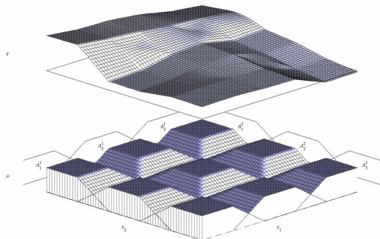
Figure III.18 : Modèle flou Takagi-Sugeno dans  $\mathbb{R}^2$ , avec  $k_1=3$  pour la variable  $x_1$  et  $k_2=3$  pour la variable  $x_2$ . La partition de l'espace d'entrée est composée de neuf règles (bas). La sortie  $y$  est une approximation linéaire par morceaux d'une fonction non linéaire (haut).
