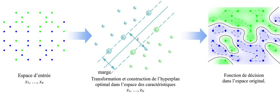
Figure III.7 : L'hyperplan séparateur optimal (avec la plus grande marge) est unique et peut être défini à l'aide des vecteurs de support (entourés). Dans le cas non linéairement séparable, le  $i^{\text{ème}}$  point a une variable de relaxation associée  $\xi_i$  représentant l'amplitude de l'erreur de classification.
