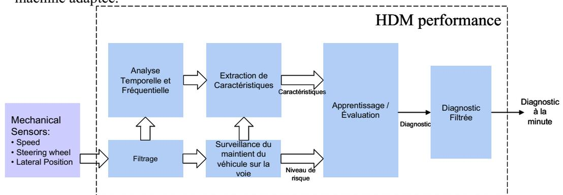
Figure IV.28 : Schéma fonctionnel du module HDM performance.
