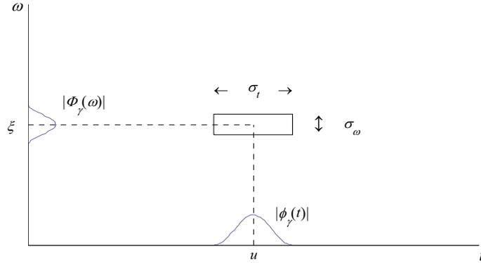
Figure II.4 : Boîte de Heisenberg représentant un atome temps–fréquence.
