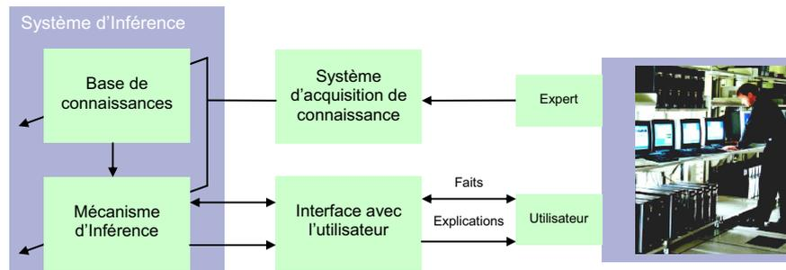
Figure III.10 : Schéma général de l'architecture d'un système expert.
