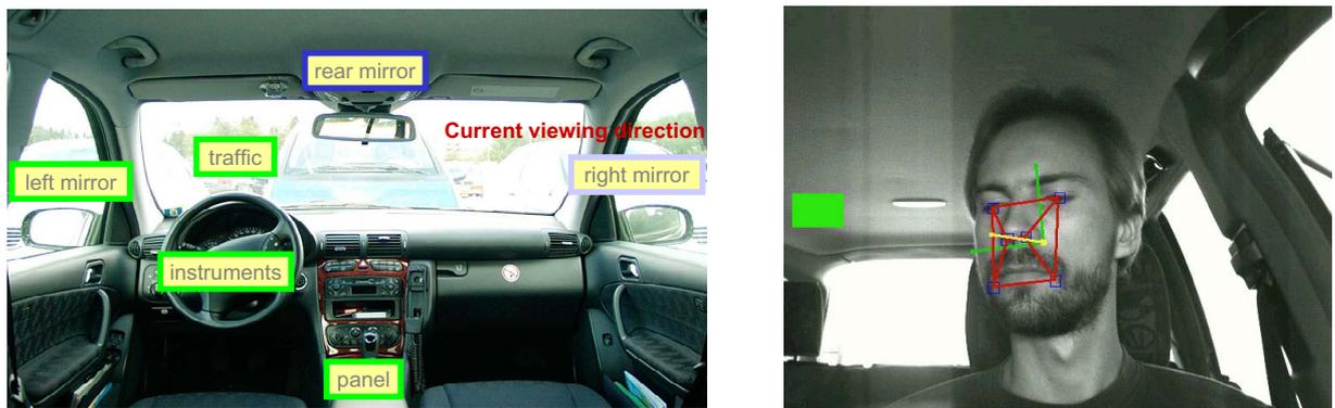
Figure IV.10 : Capteur de suivi du regard de DC.
