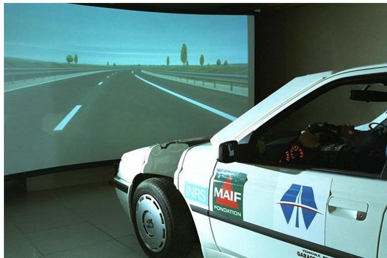
Figure IV.19 : Simulateur de conduite PAVCAS, CEPA-CNRS.
