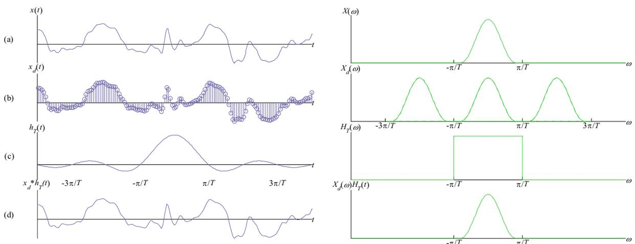
Figure II.2 : (a) Signal  $x$  et sa transformée de Fourier  $\hat{x}$ . (b) Un échantillonnage uniforme de  $x$  rend sa transformée de Fourier périodique. (c) Passe bas idéal. (d) Le filtrage de (b) par (c) reconstruit  $x$ .
