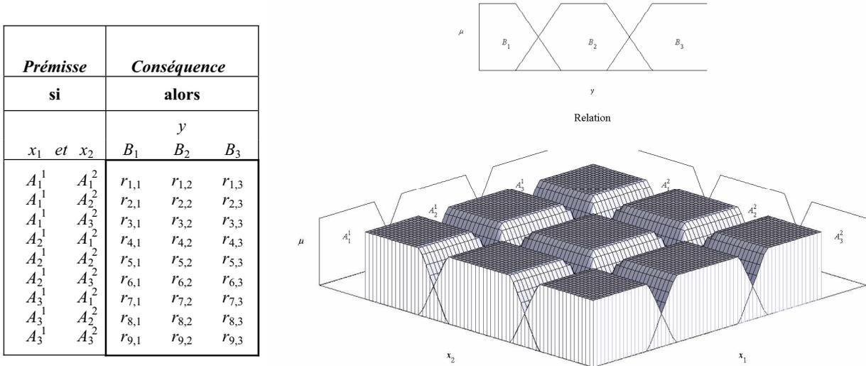
Figure III.17 : Modèle flou relationnel dans  $\mathbb{R}^2$ , avec  $k_1=3$  pour la variable  $x_1$  et  $k_2=3$  pour la variable  $x_2$ . La relation  $R$  du partitionnement de l'espace d'entrée est composée d'un total de neuf règles.
