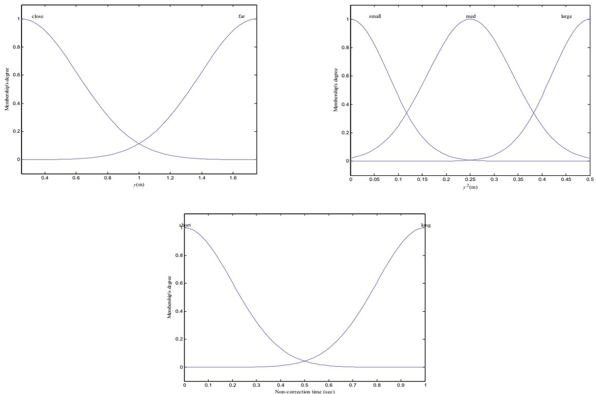
Figure IV.23 : a) Fonctions d'appartenance d'entrée pour la distance latérale et  $y$  ( $\mu_{\text{close}}$  et  $\mu_{\text{far}}$ ). b) Fonctions d'appartenance d'entrée pour la première dérivée de la distance latérale  $\dot{y}$  ( $\mu_{\text{small}}$ ,  $\mu_{\text{med}}$  et  $\mu_{\text{large}}$ ). c) Fonctions d'appartenance d'entrée pour le temps de correction  $t_{\text{nc}}$  ( $\mu_{\text{short}}$  et  $\mu_{\text{long}}$ ).
