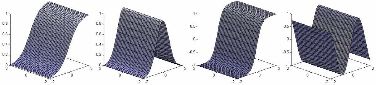
Figure III.3 : Les fonctions d'activation les plus utilisées. De gauche à droite : sigmoïdale, gaussienne, tangente hyperbolique et sinusoidale.
