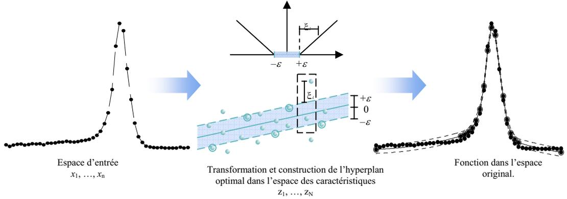
Figure III.8 : L'estimation de la régression à vecteurs de support utilisant la fonction de perte  $\varepsilon$ -insensible. Les vecteurs de support (avec  $0 < \alpha_i < C$ ), entourés, sont dans  $\pm \varepsilon$  à partir de l'hyperplan. Les autres vecteurs sont dans la zone (avec  $\alpha_i = 0$ ) où hors zone (avec  $\alpha_i = C$ ).
