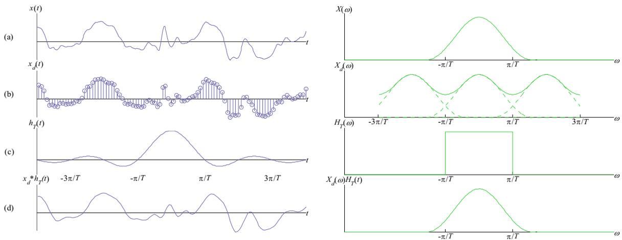
Figure II.3 : (a) Signal  $x$  et sa transformée de Fourier  $\hat{x}$ . (b) Repliement spectral dû à un recouvrement des  $\hat{x}(\omega - 2k\pi/T)$  pour différentes valeurs  $k$  (en pointillés). (d) Le filtrage de (b) par (c) génère un signal à base fréquence qui diffère de  $x$ .
