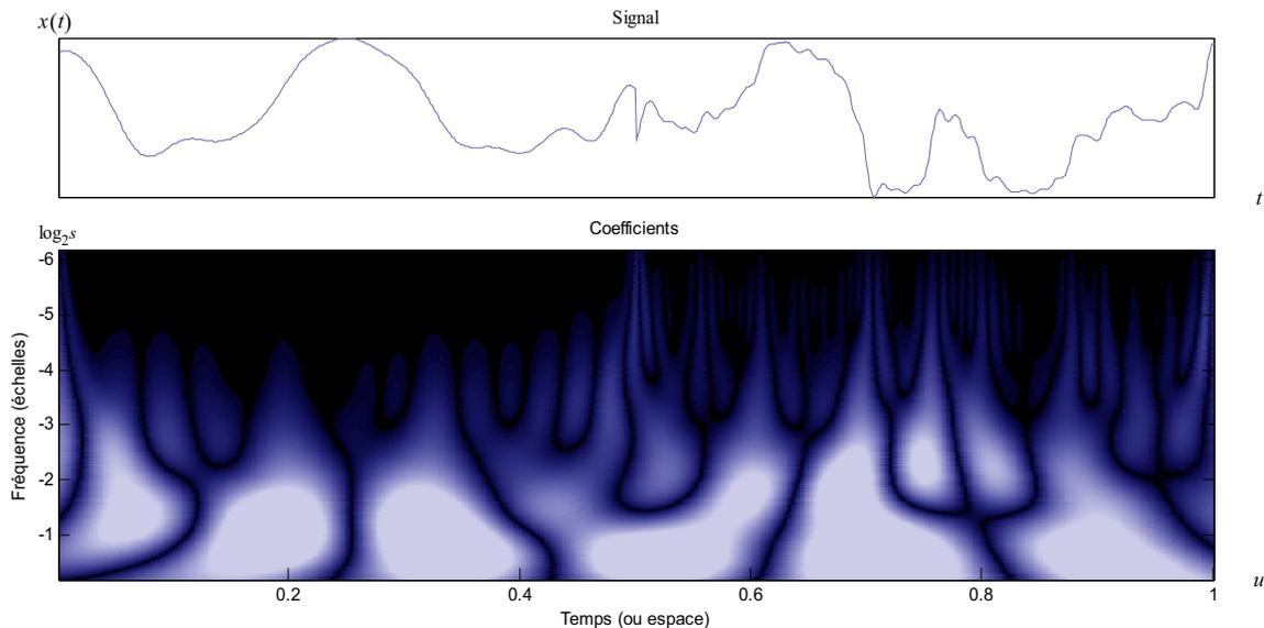
Figure II.9 : Transformée en ondelettes réelle calculée avec une ondelette en chapeau mexicain. Les axes verticaux et horizontaux représentent respectivement  $\log_2 s$  et  $u$ . Les échelles les plus fines sont en haut. Les coefficients nuls correspondent à du noir, donc à des parties régulières.
