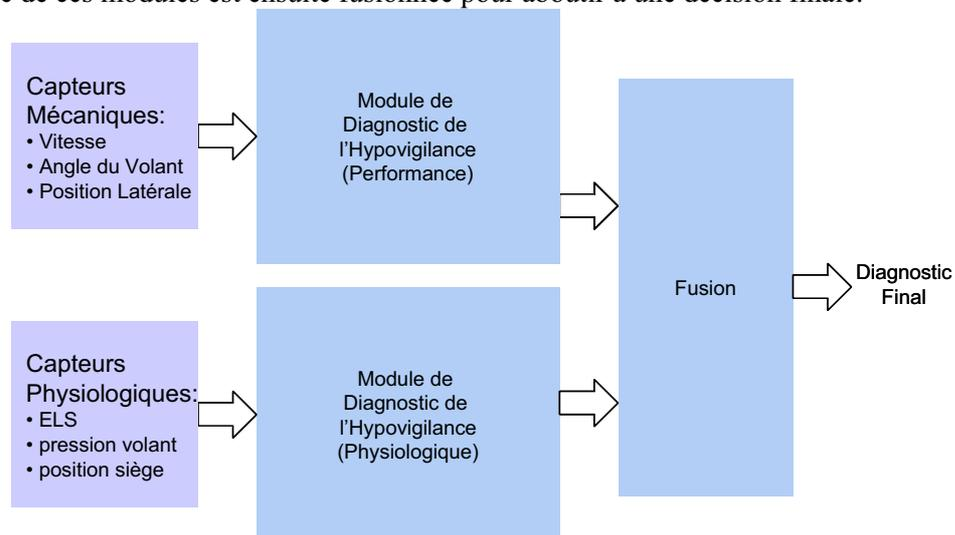
Figure IV.27 : Schéma fonctionnel du module de détection de l'Hypovigilance.
