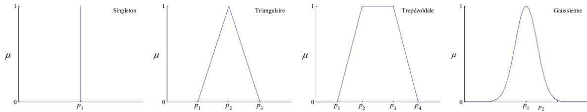
Figure III.12 : Fonctions d'appartenance : singleton, triangulaire, trapézoïdale, gaussienne.
