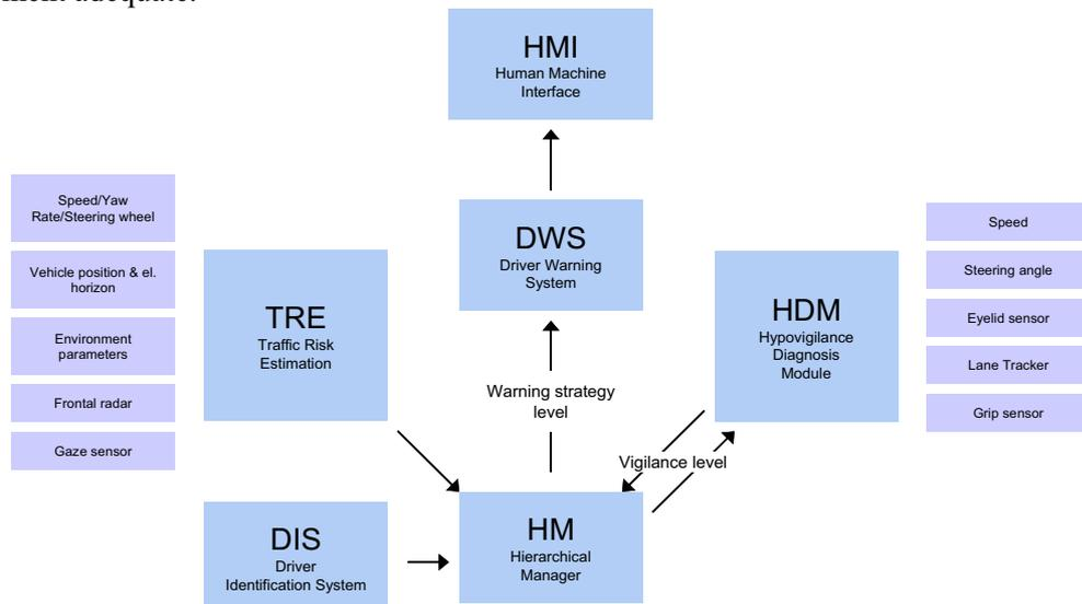
Figure IV.15 : Schéma fonctionnel AWAKE.
