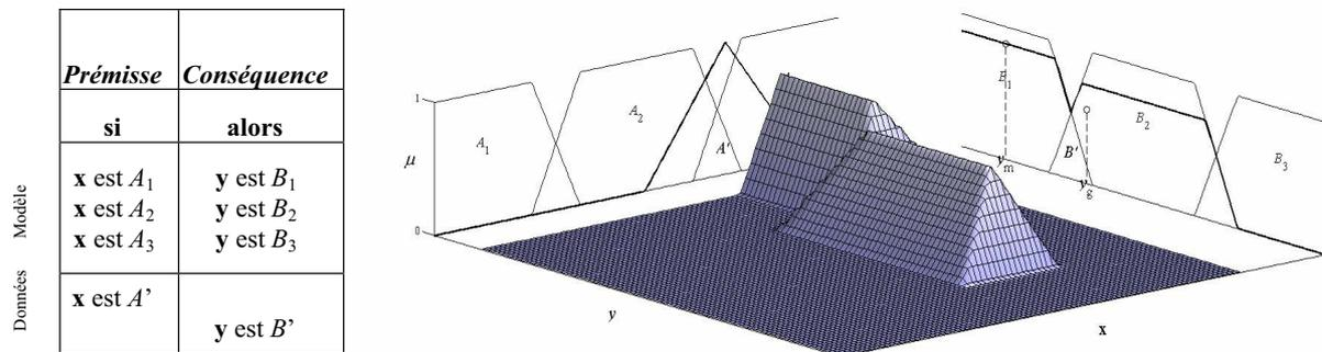
Figure III.16 : Représentation du mécanisme d'inférence max–min (Mamdani).  $A'$  est l'ensemble flou d'entrée et  $B'$  est l'ensemble flou de sortie. La défuzzification de  $B'$  par COG est  $y_g$  et par MOM est  $y_m$ .
