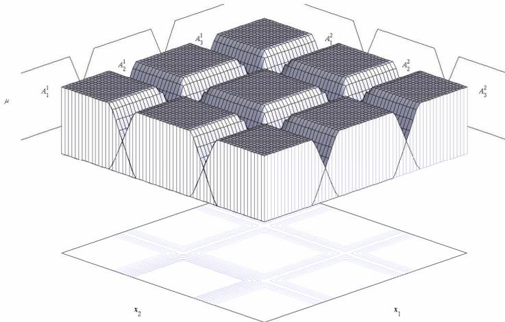
Figure III.14 : Partitionnement à l'aide des fonctions trapézoïdales sur  $\mathfrak{R}^2$ , avec  $k_1=3$  pour la variable  $x_1$  et  $k_2=3$  pour la variable  $x_2$ . Le partitionnement de l'espace d'entrée est composé de neuf règles. Les aires grisées de la partie basse de la figure montrent les régions de recouvrement des ensembles flous.
