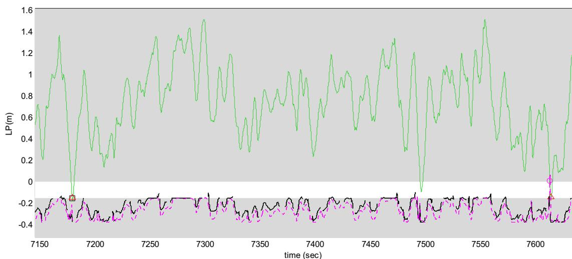
Figure IV.25 : Exemple de la trajectoire du véhicule, montrant l'effet du VRBS<sub>1</sub> (ligne en tiré long) et du VRBS<sub>2</sub> (ligne en tiré court) pour le conducteur C3. Le carré représente un avertissement du vibreur placé à 0.15 m, et le triangle un avertissement du *tlc*.
