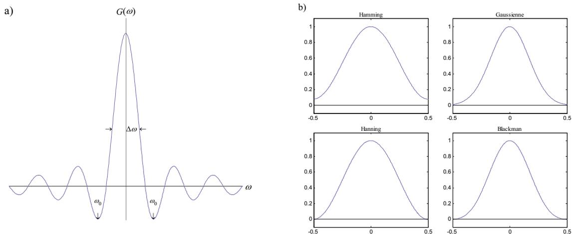
Figure II.6 : a) L'étalement de  $g$  est mesuré par sa largeur de bande  $\Delta\omega$  et par l'amplitude de ses lobes latéraux, situées en  $\omega = \pm \omega_0$ . b) Fenêtres  $g$  de support  $[-\frac{1}{2}, \frac{1}{2}]$  : Hamming, Gaussienne, Hanning et Blackman.
