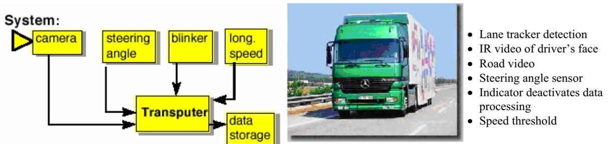
Figure IV.9 : Système de détection de somnolence de DC.
