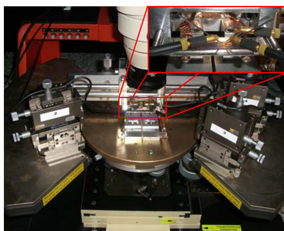
Figure III-1 : Photos du banc de flexion 4 points. Vue du banc de flexion sur une station de mesure électrique.
