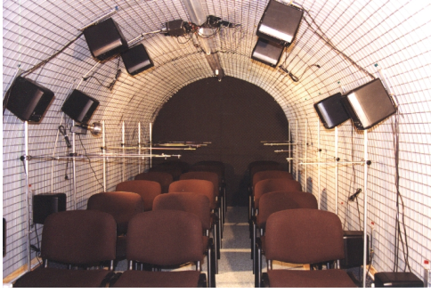
FIG. 1.3 – Cavité de mesure et valeurs singulières de la matrice de transfert entre les neuf haut-parleurs et les microphones
